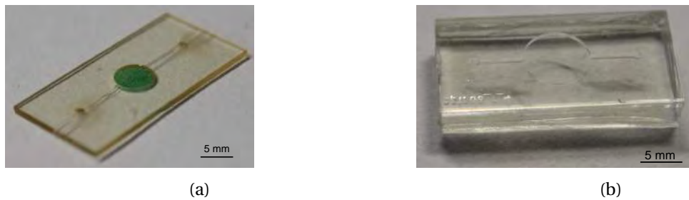
FIGURE 3.10 – Photographies du capot (a) et de la structure fluidique en PDMS (b)
