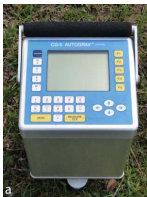
Figure 3.16 - a) Gravimètre relatif Scintrex CG-5 Autograv du parc instrumental de l'INSU. b) Schéma simplifié du capteur d'un CG-5 (modifiée d'après Dubois et al., 2011).
