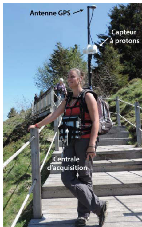
Figure 3.27 - Magnétomètre à protons utilisé lors des acquisitions réalisées dans le cadre de cette étude.
