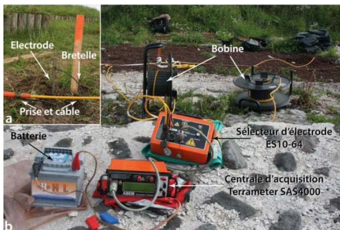
Figure 3.6 - Dispositif expérimental ERT. a) Agencement du câble et des électrodes le long du profil. b) Matériel d'acquisition.
