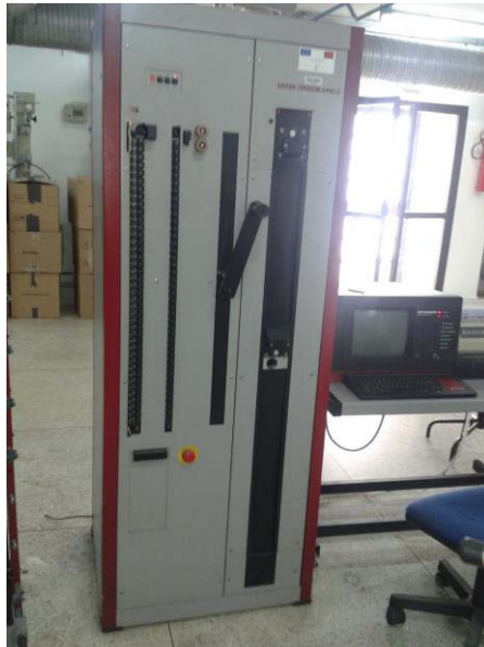
Figure II-15: Appareil Uster tensorapid pour la réalisation des essais de traction sur fils textiles.
