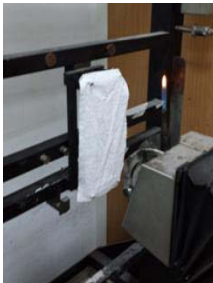
Figure III-32: Dispositif de réalisation du test d'inflammabilité.
