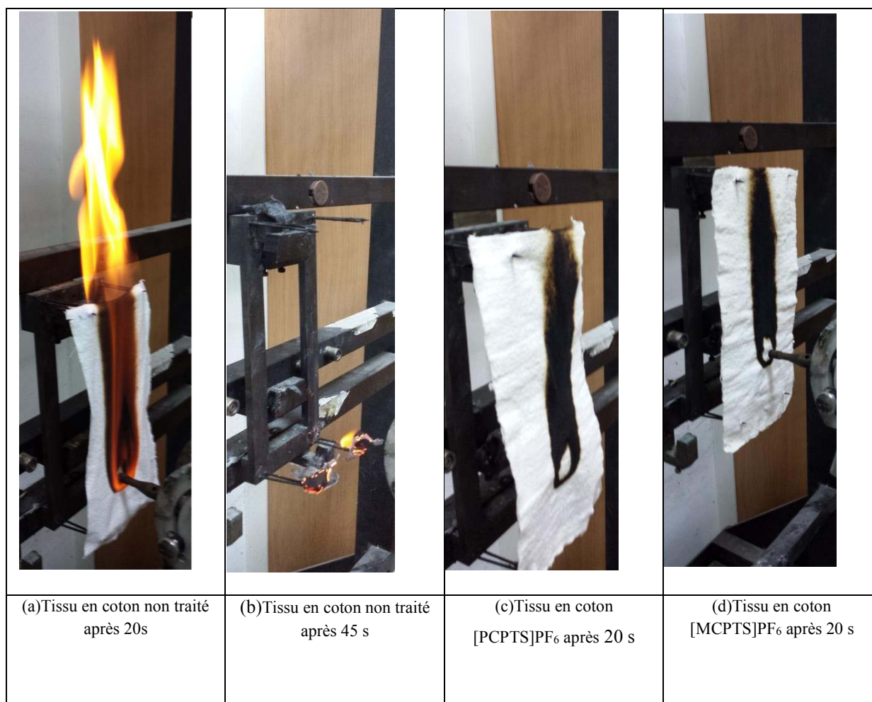
Figure III- 33: Résultats du test d'inflammabilité.
