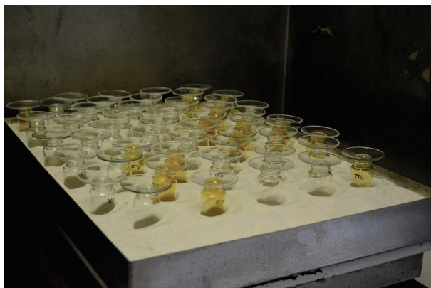
FIGURE 3.3 Phase d'incubation de l'acide nitrique avec reflux durant la minéralisation. Les verres de montre ralentissent l'évaporation et favorisent la digestion de la matière organique.
