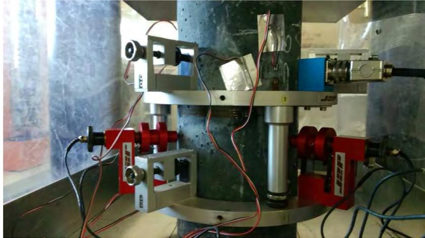
**Figure 4 - 3: Cage extensométrique pour la détermination de module d'élasticité et du coefficient de Poisson**
