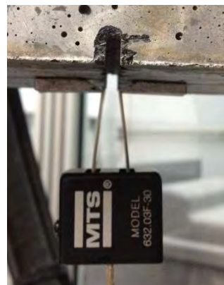
Capteur pontant fixé sur l'éprouvette pour la mesure d'ouverture de fissure
