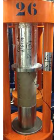
(b) Bâti de fluage en compression uniaxiale avec éprouvettes en condition endogène (en haut) et éprouvette en dessiccation (en bas)
