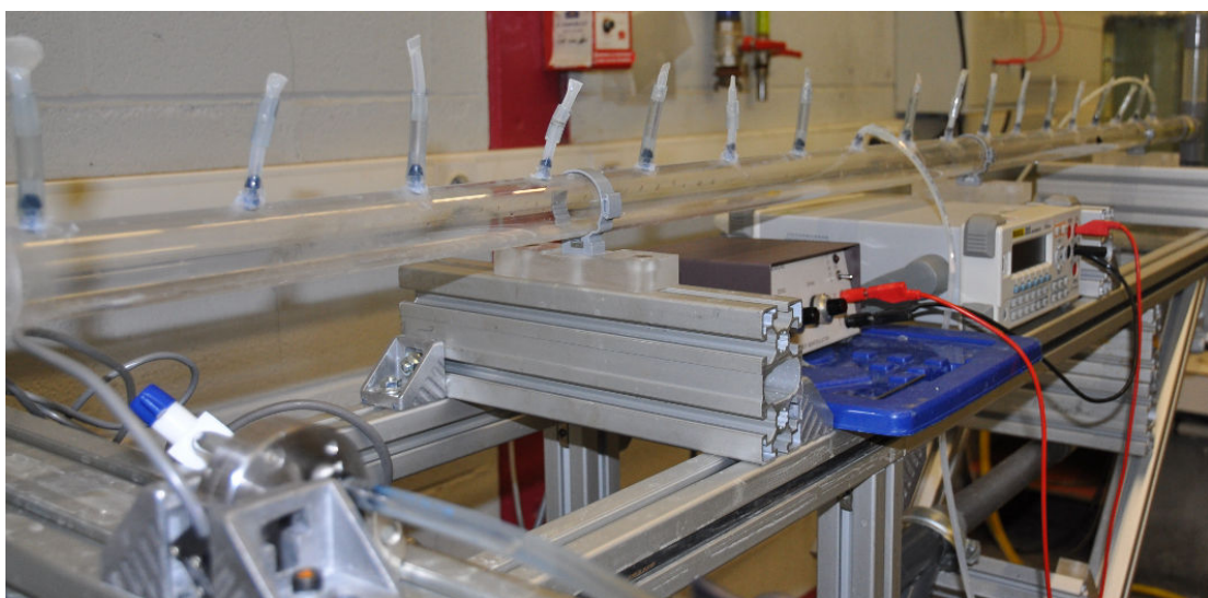
FIGURE 2.18 – Photographie du montage avec prises de pression.
