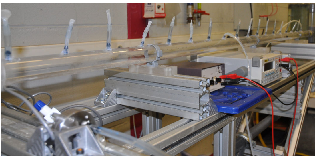
FIGURE 2.18 – Photographie du montage avec prises de pression.
