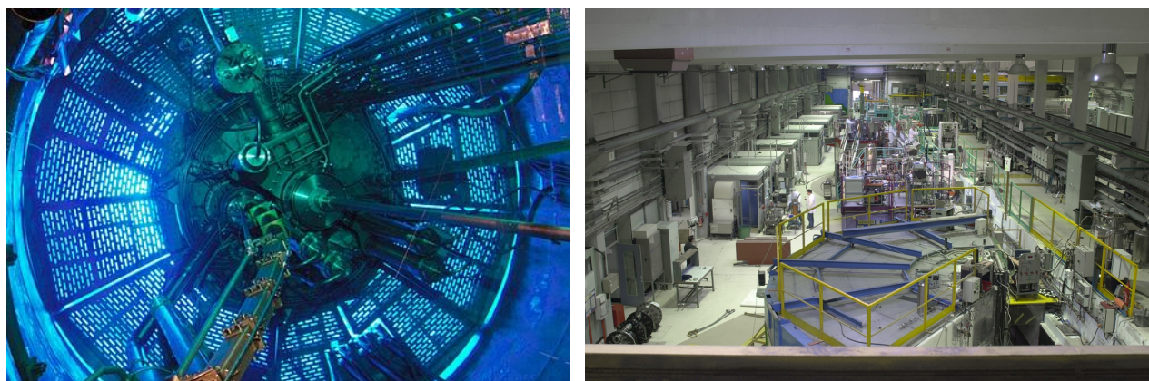
FIGURE 3.1 – Photos du réacteur à haut flux de l'Institut Laue-Langevin à Grenoble. Gauche : vue de l'intérieur de la piscine où est contenu le coeur du réacteur. Droite : hall des guides avec différents instruments. Nous pouvons voir le spectromètre temps de vol IN5 au premier plan.
