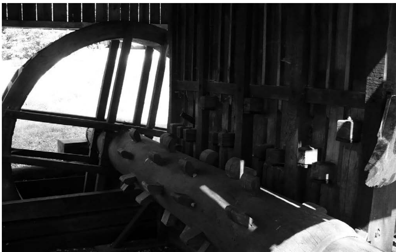
© 2013 Roșia Montană. Système de broyage du minerai d'or "șteampuri".
