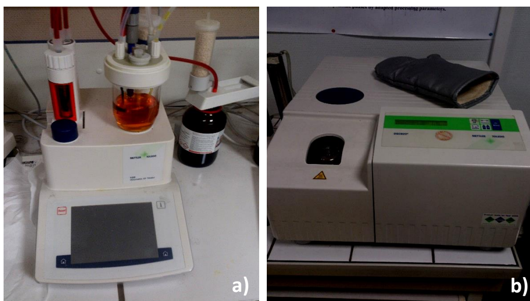
Figura 2.1. a) Titulador Karl – Fisher Metler Toledo V20, b) Equipo de calorimetría diferencial de barrido Metler Toledo DSC822e.
