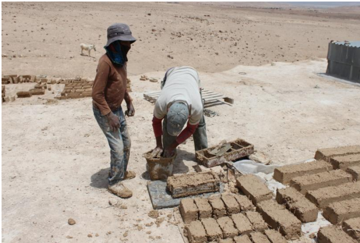
Fig. 136 : Production des briques d'adobe par le programme du MA'AN Development Center. (Photo fournie par M. le coordinateur)
