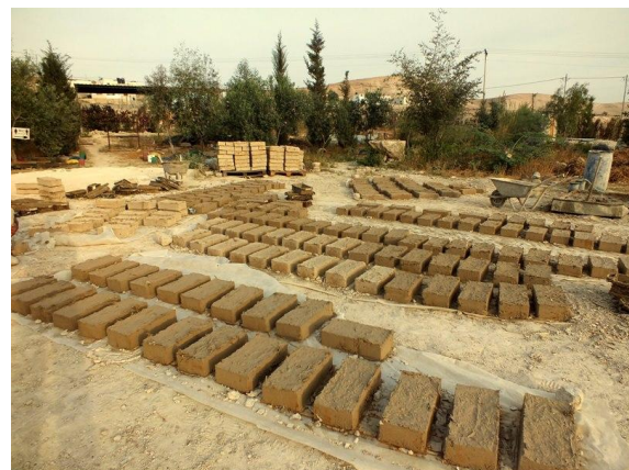
Fig. 141 : Production des briques d'adobe par El Auja environmental center (Photo fournie par le centre).
