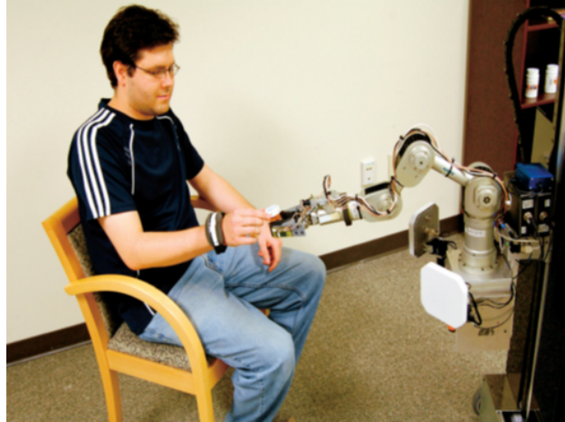
FIGURE 2.1 – Robot EL-E, équipé d'un lecteur d'étiquettes RFID UHF, remettant une boîte de médicaments munie d'une étiquette RFID à une personne portant un bracelet équipé d'une étiquette (tag) RFID [36].
