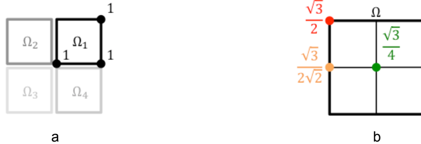
Figure I.9 : Illustration des domaines de minimisation de la fonctionnelle \Phi^2 et des incertitudes de mesure relatives associées (a) en sous-domaines \Omega_i dans le cas de la corrélation d'image locale et (b) en domaine global \Omega maillé dans le cas de la corrélation d'images globale
