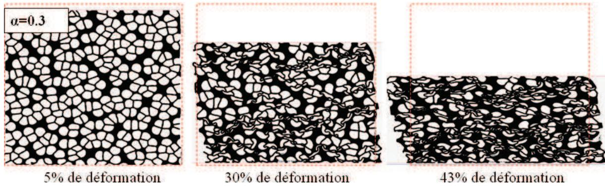
Figure 105: Comparaison à différentes étapes de déformation entre les modèles mono disperse de 70% porosité ( $\alpha=0$ ,  $\alpha=0.2$  et  $\alpha=0.3$ )
