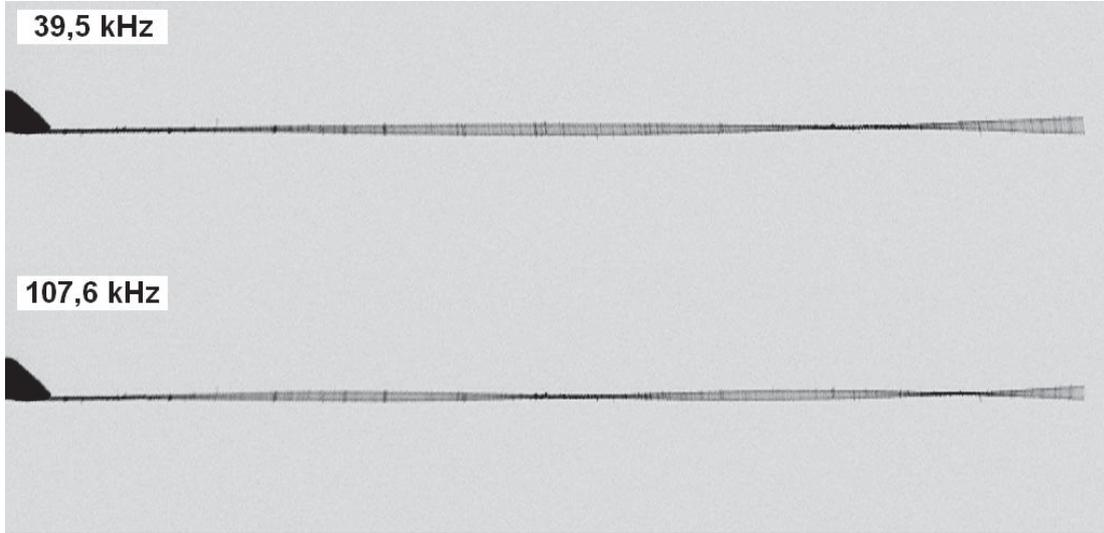
FIGURE 2.13 Deuxième et troisième mode de vibration obtenu par forçage électrostatique.
