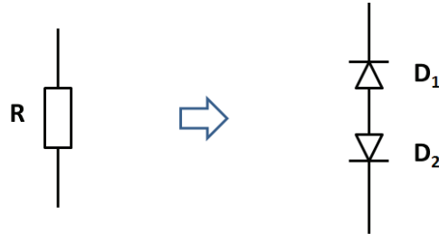
FIGURE B.2 La non linéarité de l'oscillateur de van der Pol est obtenue en remplaçant la résistance R par deux diodes identiques en série et en sens contraire.
