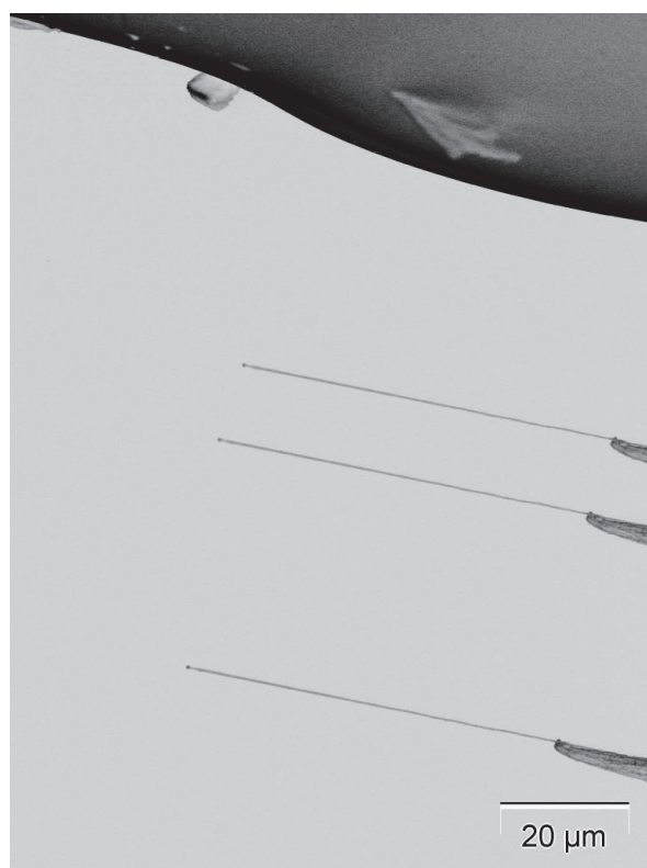
FIGURE 2.18 Image MEB en configuration parallèle à la contre électrode où l'image du nanofil de SiC est superposée pour 3 positions.
