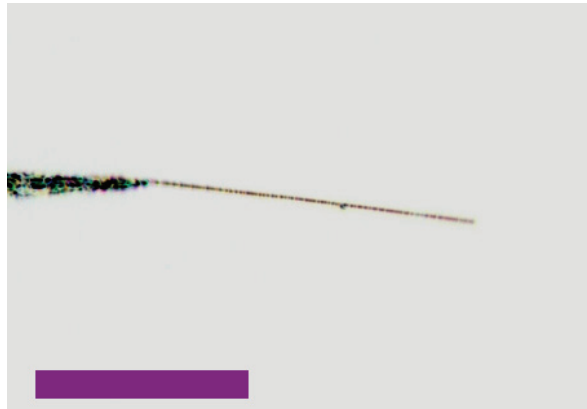
FIGURE 2.2 Image par microscopie optique d'un nanofil de carbure de silicium collé sur une pointe en tungstène. Les couleurs sont inversées. Barre d'échelle 50 \mu\text{m} .
