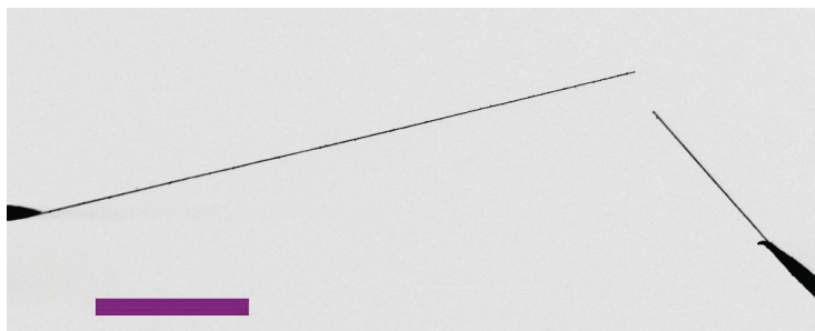
FIGURE 2.26 Le nanofil utilisé comme résonateur est celui placé à droite. Le nanofil de gauche est statique pendant la vibration du résonateur et sert de contre électrode.
