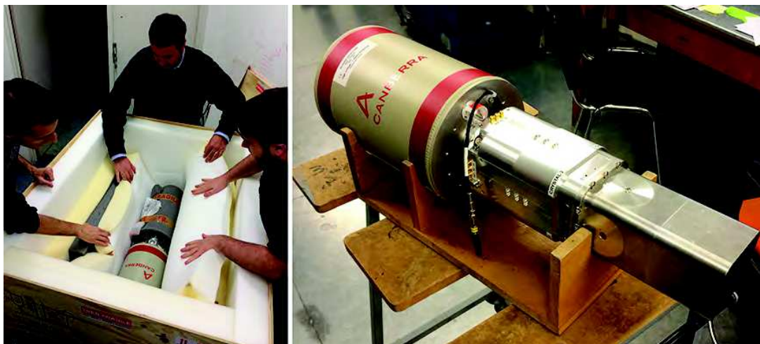
FIGURE 5.7 – Réception du détecteur clover CLODETTE à l'IPHC à Gauche. Le détecteur sur son support de test à droite.
