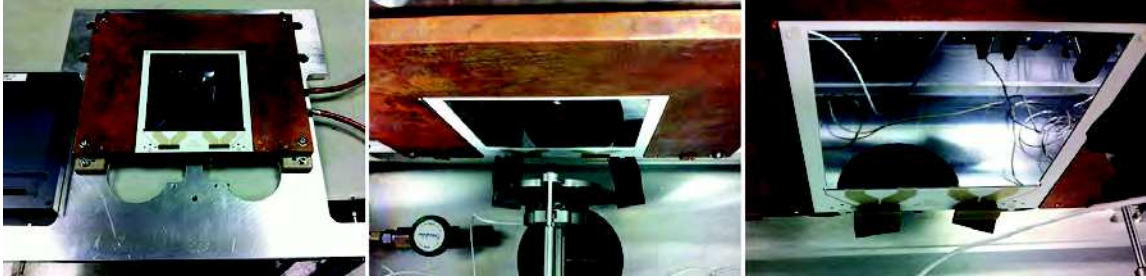
FIGURE 7.13 – Premier montage du détecteur 2D 12 sur la plaque froid à gauche. Au centre, positionnement de la plaque dans la chambre à vide du banc de test S 3 . À droite détecteur monté et connecté. Notons l’usage de connecteurs SAMTEC à 40 broches.
