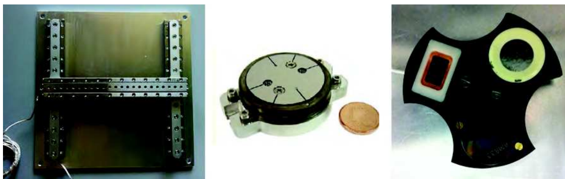
FIGURE 6.3 – Vue du système SMARACT de positionnement piézoélectrique XY à gauche, du système de positionnement angulaire au centre et à droite, vue du support de sources avec les 3 sources utilisées à Strasbourg.
