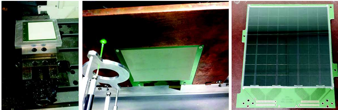
FIGURE 8.3 – À gauche la plaque SMI en cours de découpe sur la fraiseuse numérique. On notera que vu la finesse de la pièce, une pièce de support a été réalisée. Au centre plaque SMI avec connecteurs en tests de positionnement dans le banc de test. À droite, résultat d'un essai de découpe 3D sur un cadre SMI 2D. On y a monté le détecteur silicium de test mécanique.
