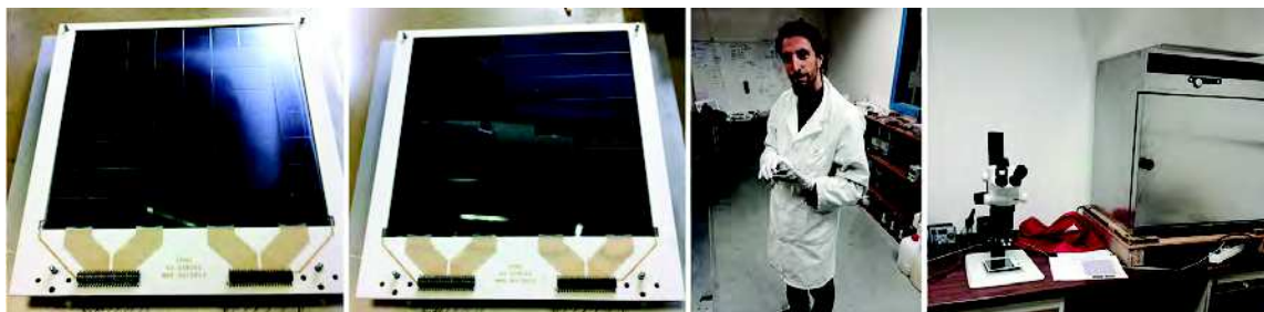
FIGURE 7.20 – À gauche on peut observer sur le détecteur 2D 12 une salissure qui semble perler en périphérie du silicium. À sa droite, le même détecteur après nettoyage. Les manipulations des détecteurs se font avec des gants pour éviter toute salissure. À droite, on peut observer l'étuve servant au nettoyage et la loupe binoculaire servant à inspecter le détecteur et à vérifier l'intégrité des bonds après nettoyage.
