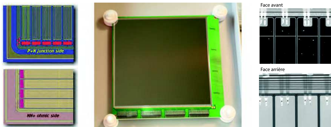
FIGURE 2.6 – Vue du détecteur d’implantation DSSD. À gauche, vue technique des strips et de la grille s’y trouvant [MIC10] . Au centre et à droite, photo du détecteur dans sa boîte et détail des strips [The14b].
