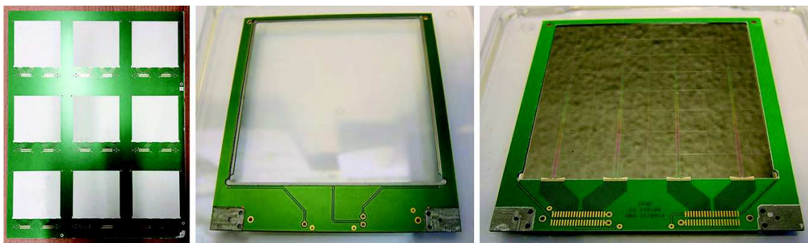
FIGURE 8.2 – Prototype de support aluminium sérigraphié 2D. À gauche la plaque de 9 supports telle que reçue du fournisseur. Au centre plaque sérigraphiée découpée, lamée et anodisée (vue côté jonction). À droite, le même support avec le silicium de test mécanique (vu côté ohmique).
