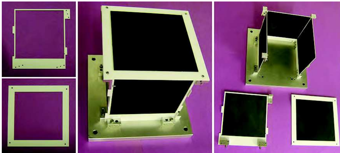
FIGURE 7.4 – Vue de la maquette thermique "3D". À gauche, détails des cadres nus, en bas à droite, les mêmes cadres, avec les plaques de graphite et les pièces aluminium de montage. En haut à droite, la version avec 3 Tunnel montés et au centre la version entièrement montée.
