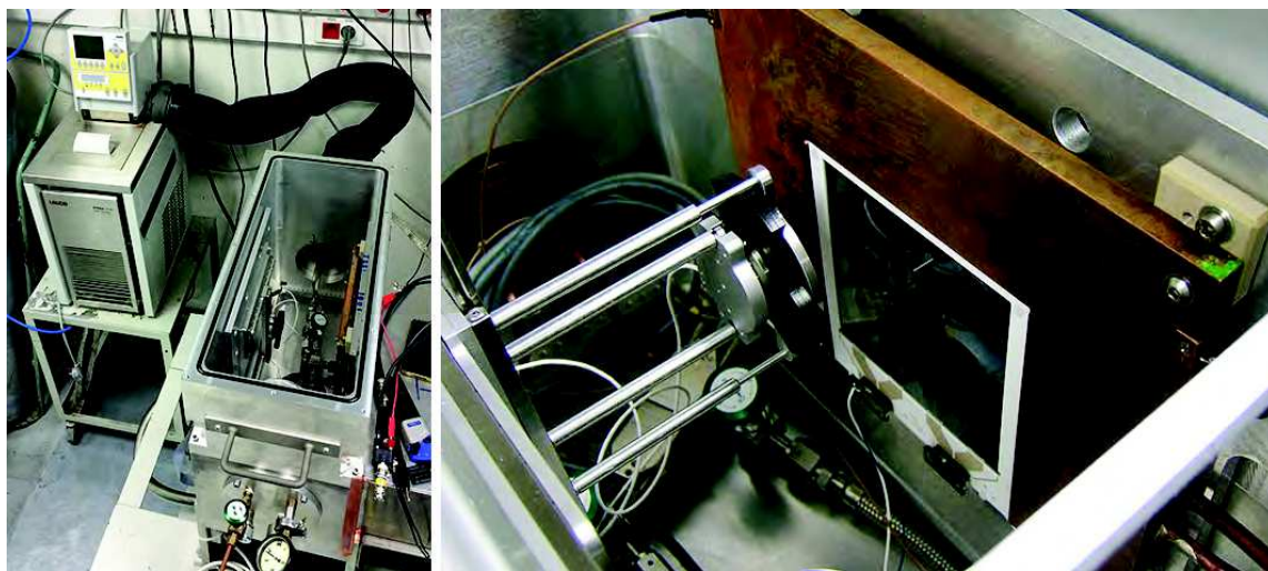
FIGURE 6.2 – Vue du système LAUDA à gauche et du circuit froid à l'intérieur de la chambre à réaction. Dans un premier temps la plaque froide était taillée pour recevoir directement le silicium. À l'arrivée des détecteurs de présérie, elle a été modifiée afin d'accueillir une plaque froide "fille" dédiée à un type de silicium (cf. Chapitre 8). On peut noter que le support de sources rotatif est monté directement sur la règle XY et est dépourvu de collimateur sur la vue de gauche pour toucher tout le détecteur alors que sur l'image de droite, il est sur les tiges de prolongation et derrière le collimateur pour viser un pixel précis.
