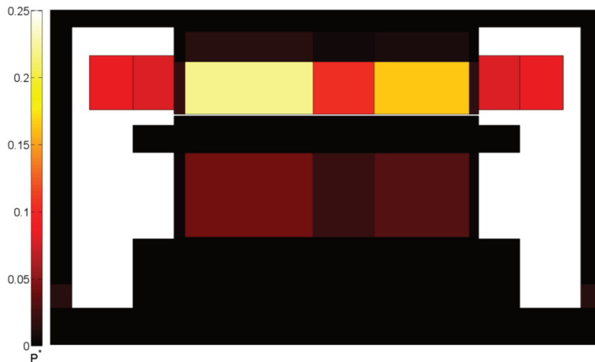
Figure 2.23. Répartition des pertes dans la machine dans SAME
