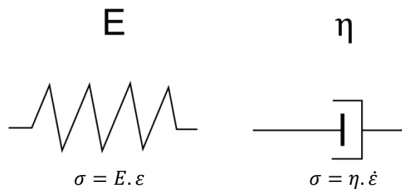
Figure 2-3 Eléments de bases pour les modèles rhéologiques
