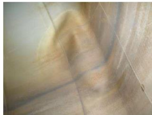
B. Cloque d'un liner PVDF
