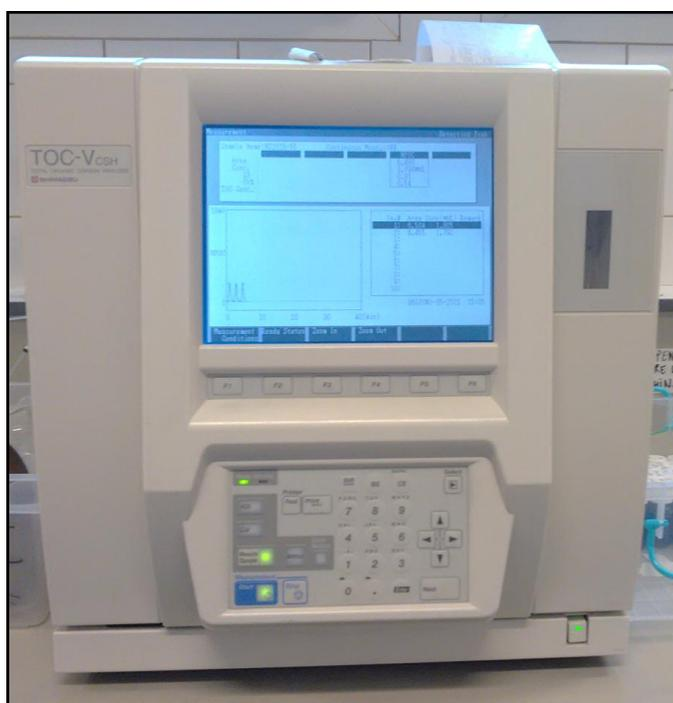
**Figure 2.13.** Photographie de l'analyseur de carbone organique total de type Shimadzu TOC-Vcsh.
