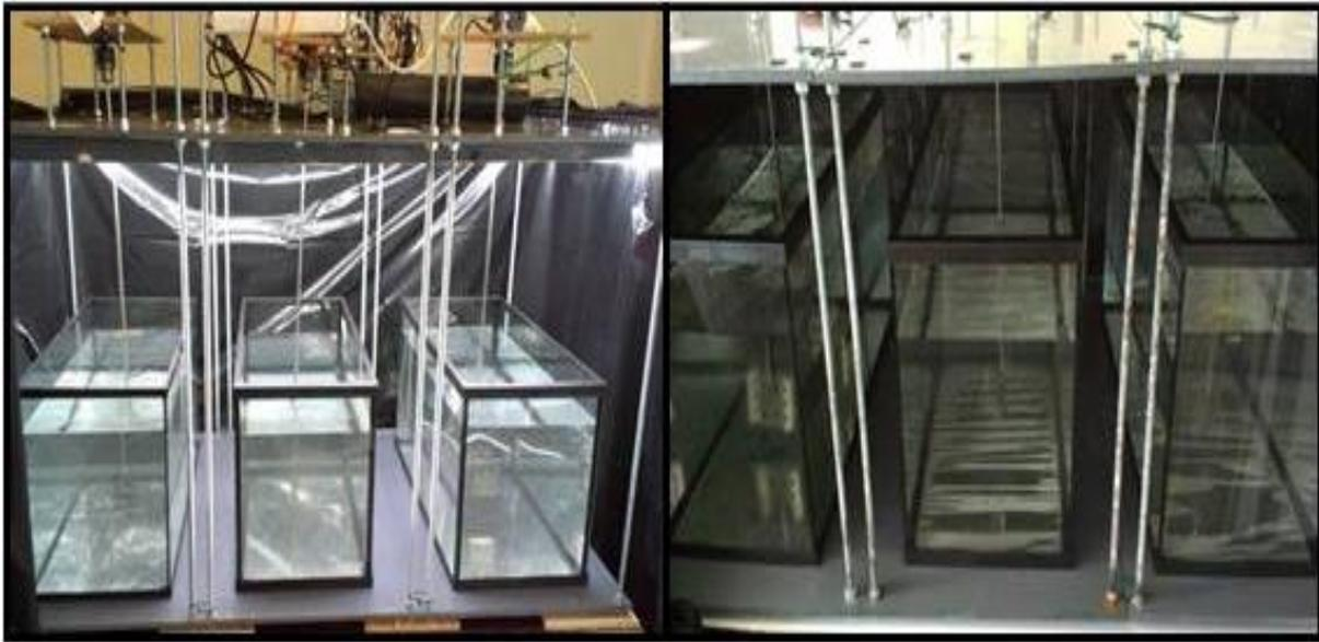
**Figure 2.11.** Photographie des dispositifs expérimentaux utilisés pour l'incubation de l'eau de mer. A gauche, le dispositif est équipé de deux tubes de lumière froide permettant de fournir un éclairage de  $200 \mu\text{E} \cdot \text{m}^{-2} \cdot \text{s}^{-1}$ . Le dispositif de droite n'en étant pas équipé afin de maintenir les aquariums au noir.
