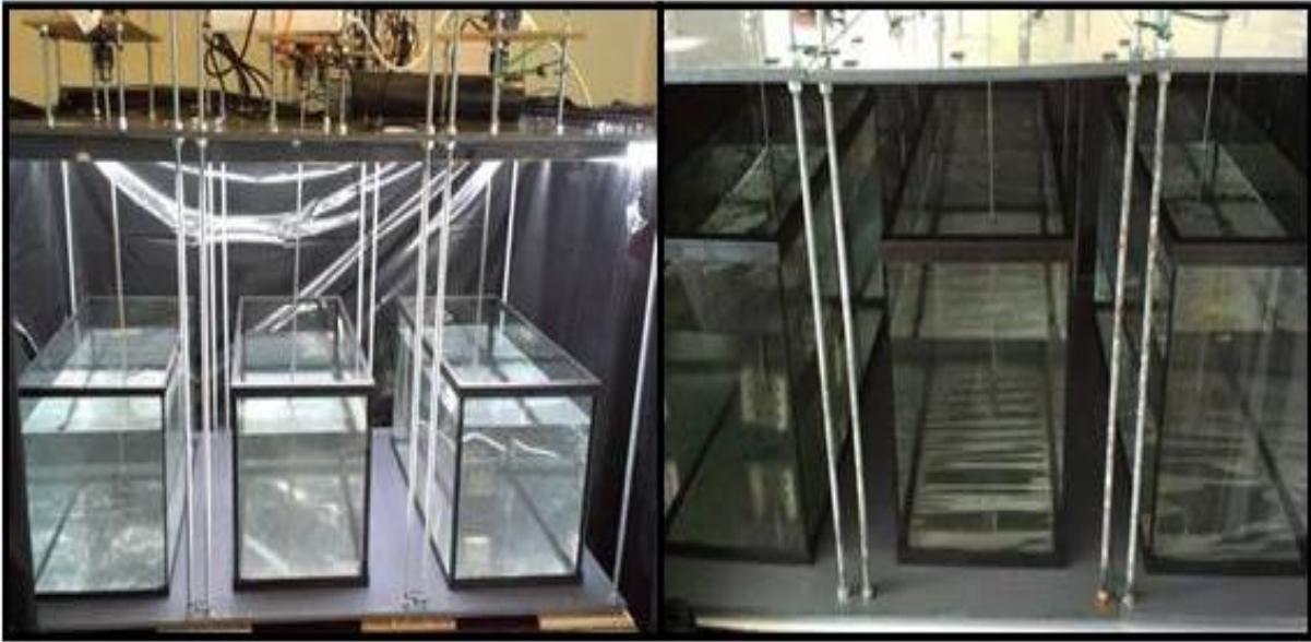
Figure 2.11. Photographie des dispositifs expérimentaux utilisés pour l'incubation de l'eau de mer. A gauche, le dispositif est équipé de deux tubes de lumière froide permettant de fournir un éclairage de 200 \mu\text{E.m}^{-2}.\text{s}^{-1} . Le dispositif de droite n'en étant pas équipé afin de maintenir les aquariums au noir.
