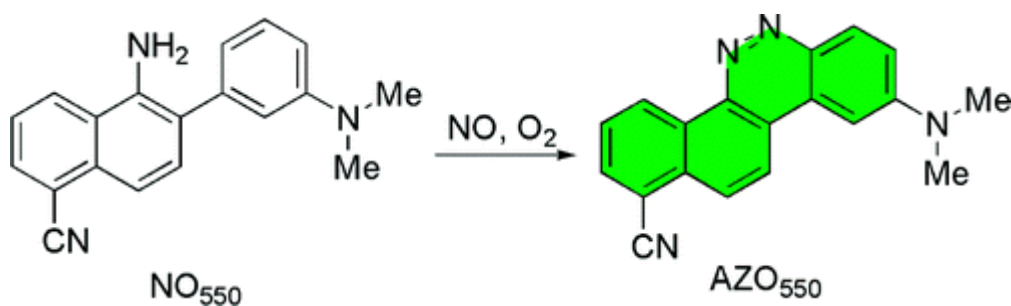
Figure 18 Réaction entre le NO et la sonde NO550 pour donner le composé fluorescent AZO550. D'après (Yang et al., 2010)
