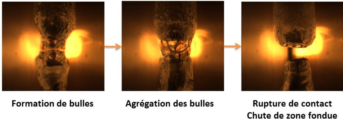
Figure II.34 : Photographies de la zone fondue obtenues par caméra CCD illustrant la coalescence de bulles
