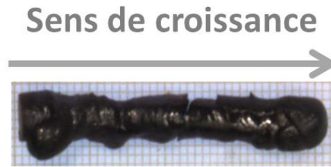
Figure II.13 : Barreau solidifié La6 d'une croissance à partir d'un barreau d'alimentation céramique \text{Ba}_2\text{LaFeNb}_4\text{O}_{15} fritté 60 h à 1340^\circ\text{C} .
