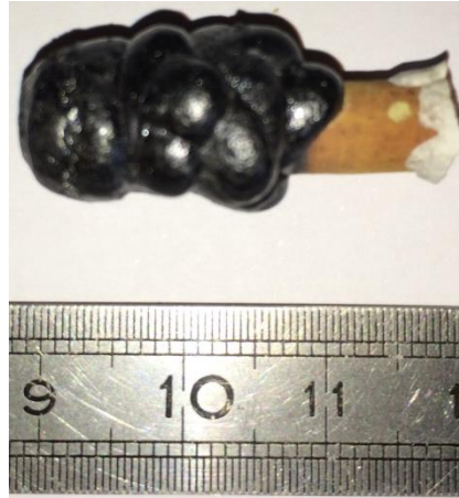
Figure II.36 : Photographie du barreau solidifié Nd3, issu d'un barreau de composition Ba_{2,10}Nd_{0,9}Fe_{0,95}Nb_{4,05}O_{15} .
