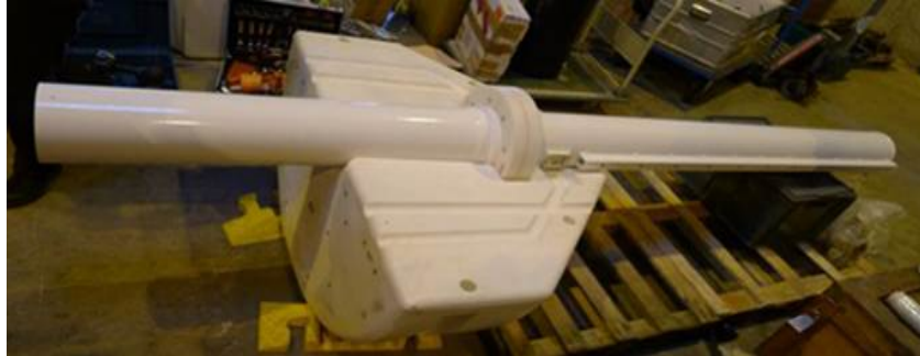
FIGURE 4.2 – Photo du tube bloqué dans une moitié de la flottabilité de la bouée. La longueur finale (environ 3m) est obtenue en associant deux tubes qui sont fixés de manière étanche l'un à l'autre au niveau du cimblot.
