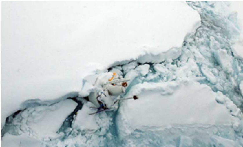
FIGURE 5.4 – Bouée IAOOS 4 sur le point d'être récupérée lors de la campagne N-ICE 2015. Cette photo montre clairement les conséquences possible des crêtes de compression et des "leads" sur l'inclinaison de la bouée.
