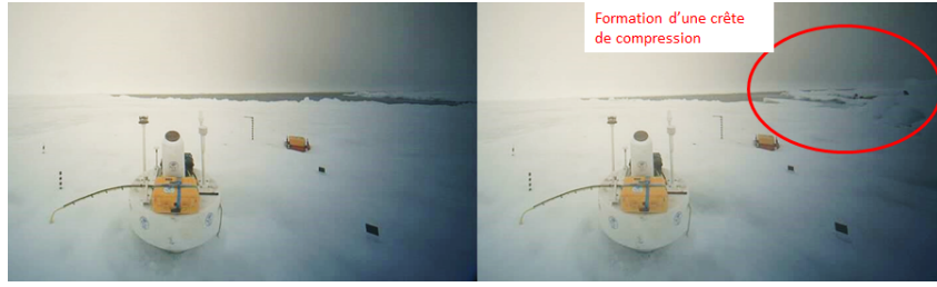
FIGURE 5.16 – Deux dernières photos reçues de la caméra indépendante faisant face à la bouée pendant la campagne Barnéo. Le début de formation d’une crête de compression, probablement à l’origine de l’inclinaison importante de la bouée pendant cette seconde période, est visible sur la droite.
