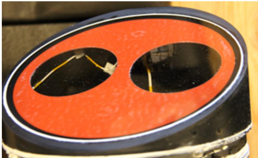
FIGURE 4.18 – Photo du hublot monté sur son porte hublot avec une inclinaison de  $25^\circ$  et équipé de sa résistance chauffante rouge collée sur sa face interne. Les fils d'alimentation de la résistance sont visibles à travers le hublot. Ceux-ci sont fixés le long de la face interne du tube et descendent se connecter aux batteries.
