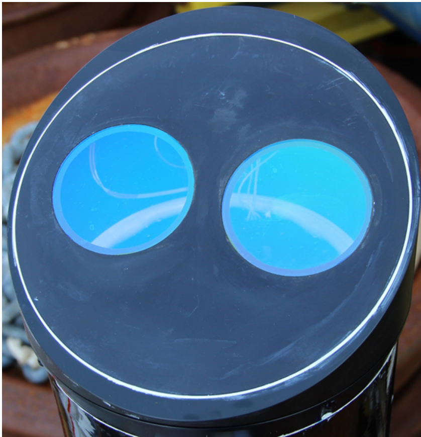
FIGURE 4.19 – Photo du nouveau système chauffant. Les deux hublots en saphir sont légèrement teintés car un traitement anti-reflet a été appliqué. Ils sont encastrés dans une plaque d'aluminium ici peinte en noire, au dos de laquelle est collée la résistance chauffante rouge qu'on pouvait voir à travers le hublot de la première version.
