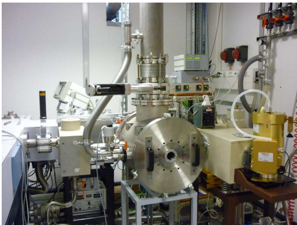
Figure VII-2: Vue générale du spectromètre à transformée de Fourier couplé au jet continu Jet-AILES
