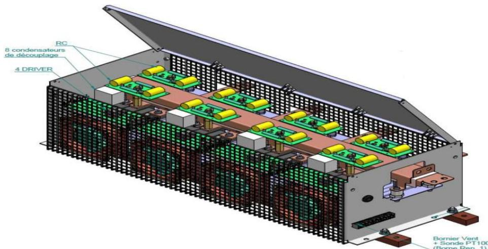
Figure B. 2: Convertisseur 4 bras (600A, 60V, 40kHz)
