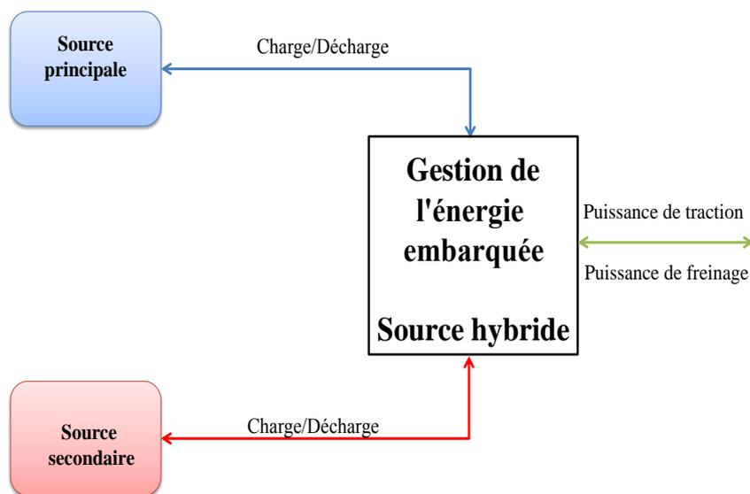
Figure. I. 10: Principe d'hybridation des sources de stockage hybrides
