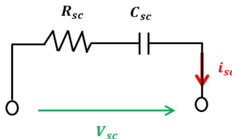
Figure. II. 34: Modèle « constructeur RC »
