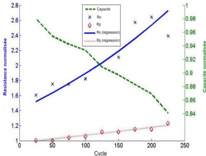
Figure. II. 9: Évolution de la résistance interne ( $R_0$ ) et de la capacité en fonction du nombre de cycles [117]
