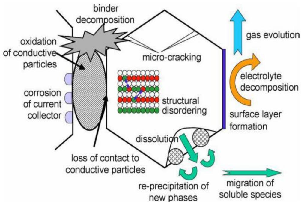
Figure. II. 7: Sources principales du vieillissement de la cathode [95]
