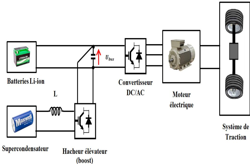
Figure. I. 18 : Architecture utilisée sur le banc expérimental ESTACA-Laval
