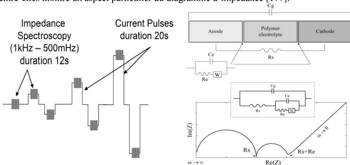
Figure. II. 24: Identification fréquentielle [178]
