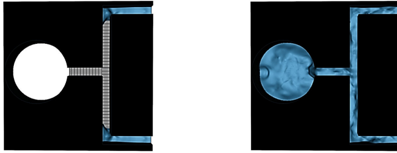
FIGURE 7.12 – Simulation d’un épandage à deux composants dans des canaux de déversement pour un modèle D3Q19 : le premier composant est présent sous sa forme liquide et gazeuse alors que le second est présent uniquement sous forme gazeuse. Ce cas de figure peut représenter une simulation contenant du GNL sous sa forme liquide et gazeuse en interaction avec l’air présent uniquement sous forme gazeuse.
