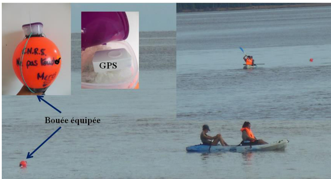
Figure 2.6: Dispositif de la bouée équipée de GPS sous le principe de dérive lagrangienne
