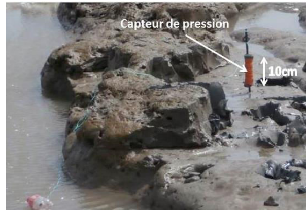
Figure 2.5: Capteur de pression déployée sur la vasière. Le capteur est fixé sur un fer à béton de 2m enfoncé dans la vase.
