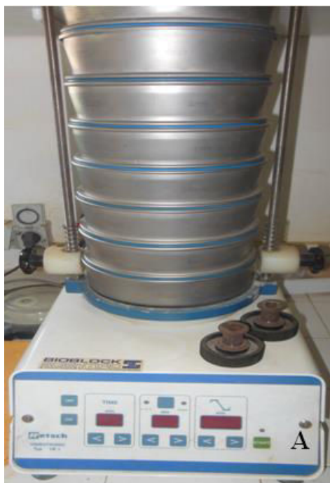
Figure 2.20: A/ Colonne granulométrique, B/ Exemple de résultats de pourcentage de refus au tamis pour un échantillon
