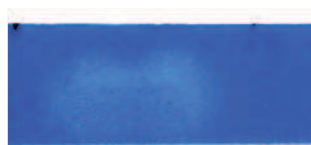
Figure 3.17 : Résultat du film EBT pour la couronne au « contact après » montrant l'empreinte liée à l'atténuation.
