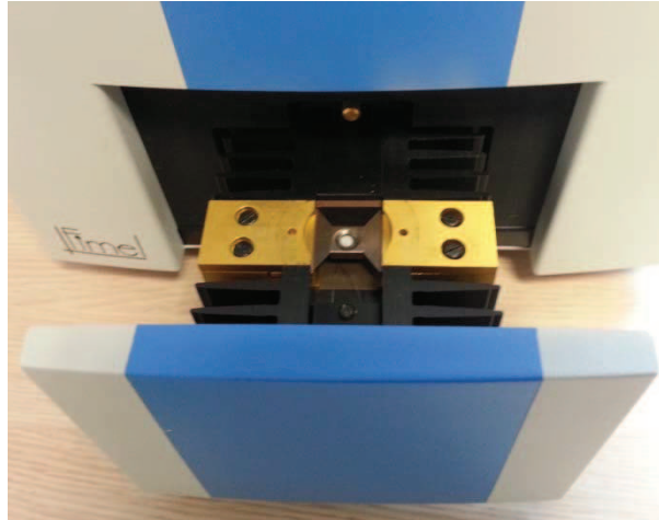
Figure 3.2 : Plaque chauffante avec un TLD.
