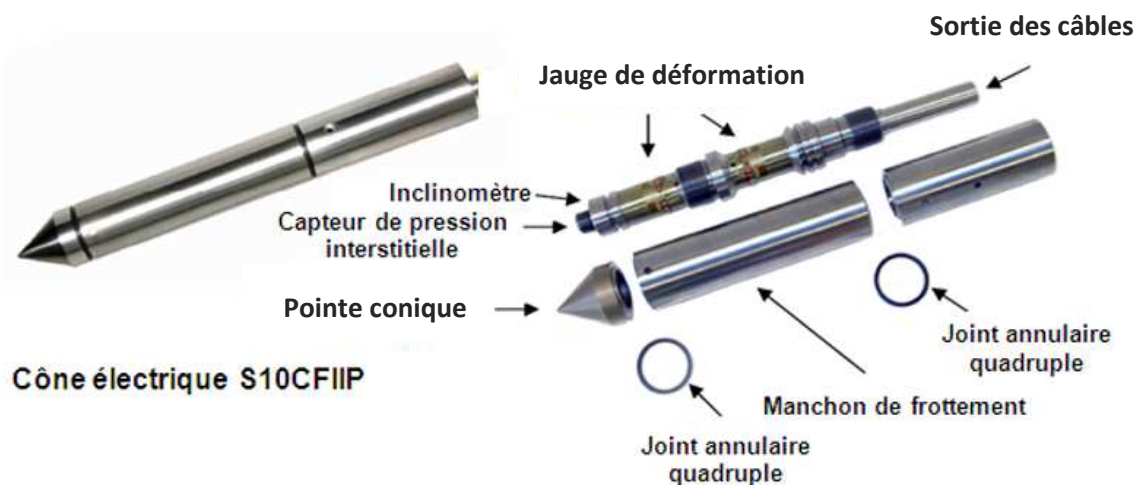
Figure II - 8 - Vue du piézocône S10CFIIP (Ø 36 mm)
