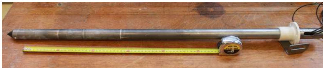
Figure II - 6 - Vue de la sonde-pieu instrumentée (Ø 36 mm)
