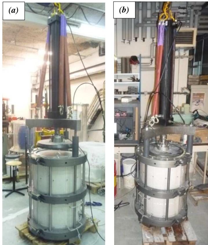
Figure II - 24 - (a) Mise en place du système de chargement ; (b) consolidation en cours
