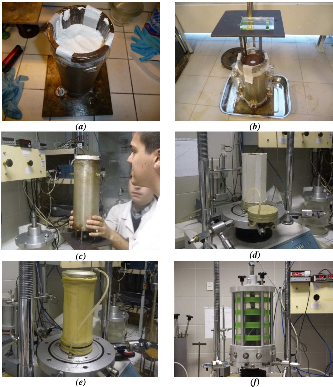
Figure II - 42 - Différentes étapes de l'essai triaxial : (a) mise en place de la boue de kaolinite dans le consolidomètre ; (b) consolidation ; (c) extrusion de l'éprouvette ; (d) mise en place de l'éprouvette sur l'embase inférieure ; (e) mise en place de la membrane (f) phase de cisaillement
