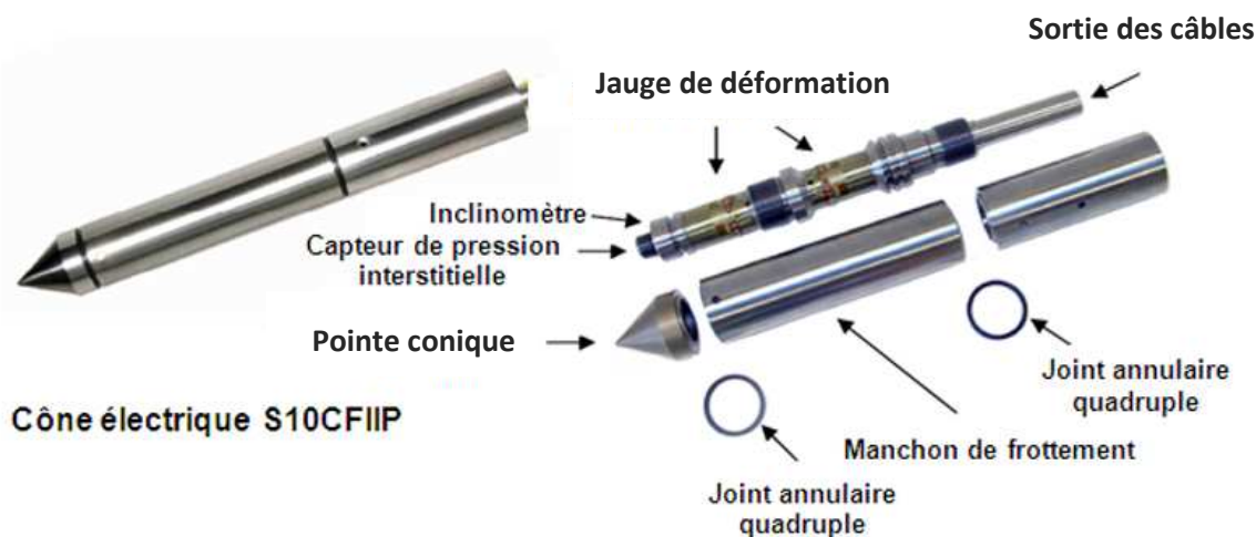
Figure II - 8 - Vue du piézocône S10CFIIP (Ø 36 mm)
