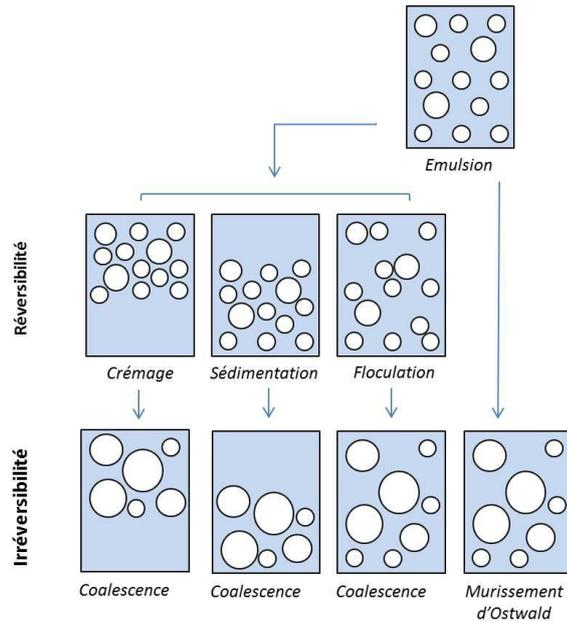
Figure II-2 : phénomènes de déstabilisation d'une émulsion
