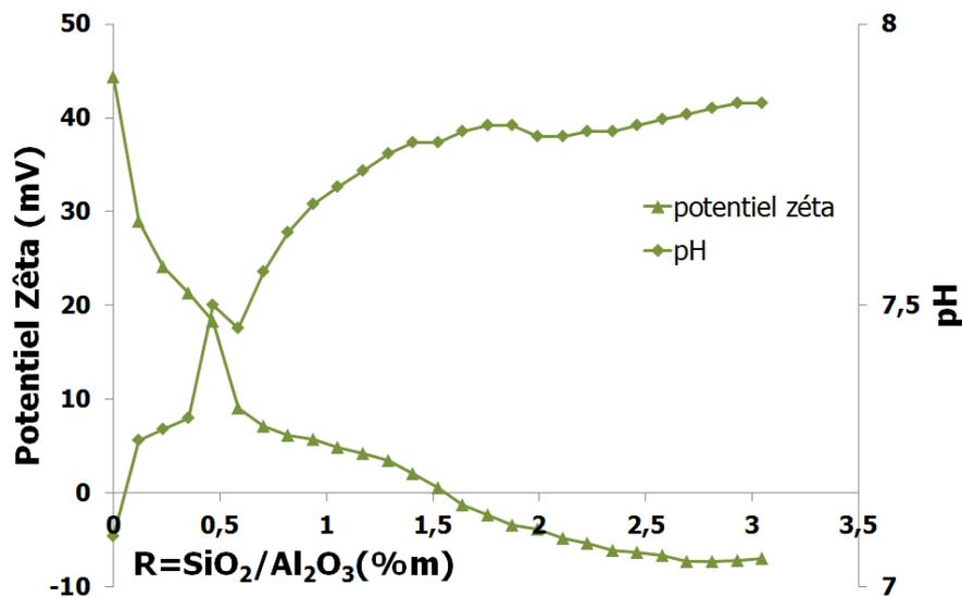
Figure IV-10 : évolution du potentiel zêta et du pH d'une suspension d'alumine 3%v en fonction de l'ajout progressif de Ludox TM50
