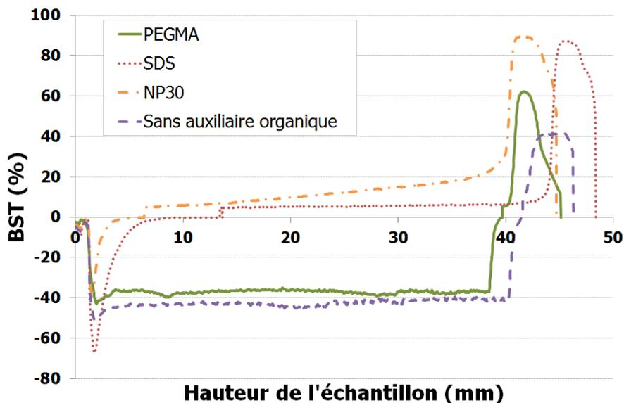
Figure II-15 : analyse en rétrodiffusion et en transmission à  $t=6h$  des émulsions avec pour auxiliaires organiques le PEGMA (1,2g/L), le SDS (17,3g/L), le NP30 (3,5g/L) et une émulsion sans auxiliaire organique
