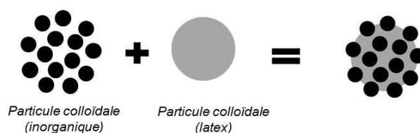
*Figure I-11 : morphologie de particules hybrides obtenues par hétéroagglomération*
