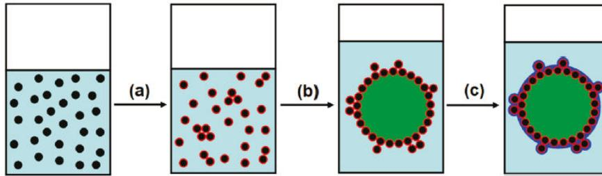
Figure III-4 : formation de microcapsule : (a) modification de la surface du Ludox CL par le PSS (b) émulsification pour former une émulsion de Pickering O/W (c) assemblage couche par couche de polyélectrolytes pour former des microcapsules
