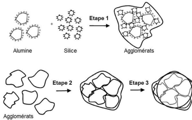
Figure IV-6 : schéma des étapes du procédé d'hétérocoagulation [7]
