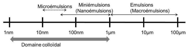
Figure II-1 : terminologies utilisées en fonction de la taille des gouttelettes d'émulsion
