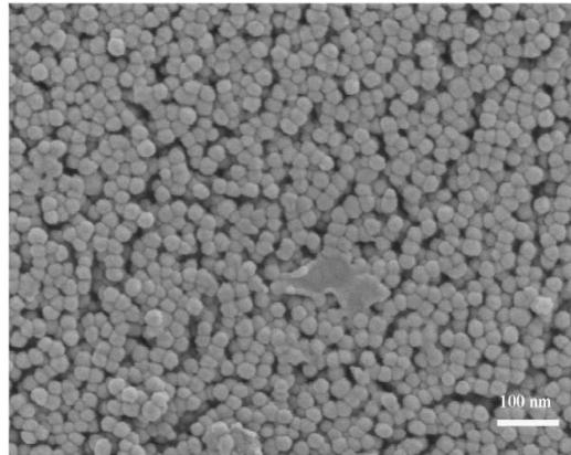
*Figure II-8 : image MEB des particules de silice du Ludox TM50 [7]*
