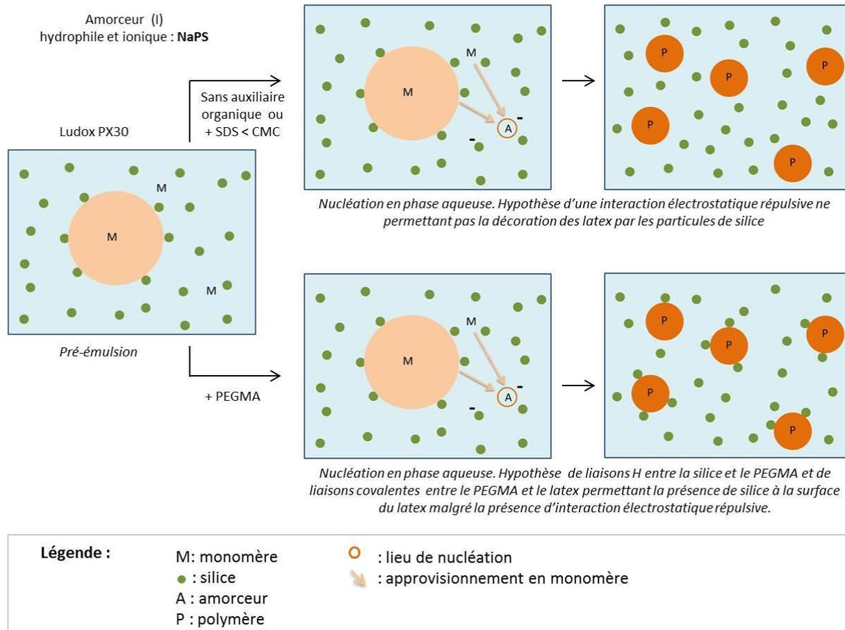
Figure II-33 : mécanisme de nucléation homogène coagulative
