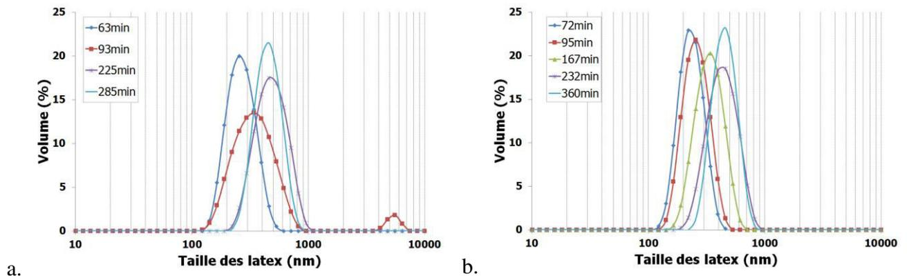
Figure A4-2 : évolution des distributions granulométriques des latex formés au cours des synthèses a. en présence de macromonomère PEGMA – b. sans auxiliaire organique
