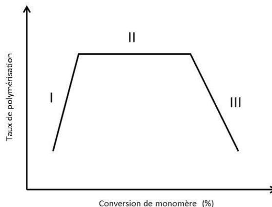
Figure I-7 : taux de polymérisation en fonction de la conversion du monomère (%) pour chaque étape du processus (I : nucléation, II : croissance, III : stabilisation)
