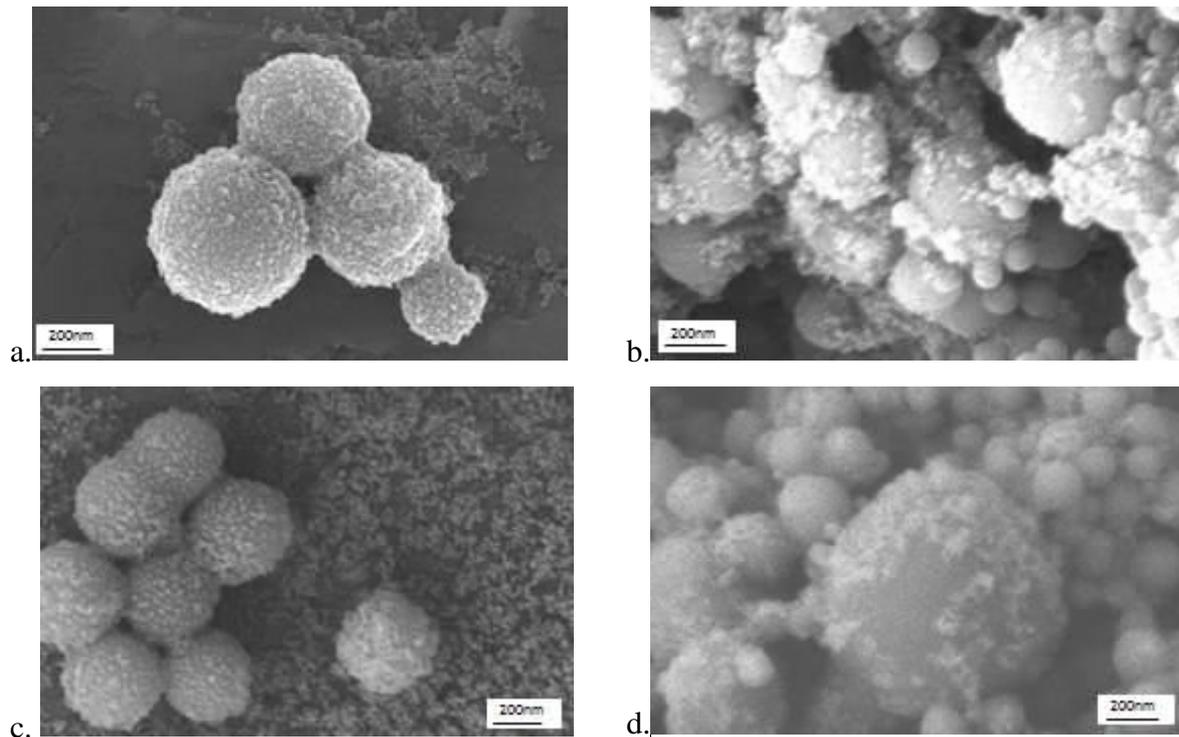
*Figure III-16 : images MET de particules obtenues par polymérisation en émulsion en présence de différentes silices et amorceurs a. Ludox CL+ NaPS - b. Ludox CL + PSS + NaPS -c. Ludox CL +AIBN -d. Ludox CL + PSS + AIBN*
