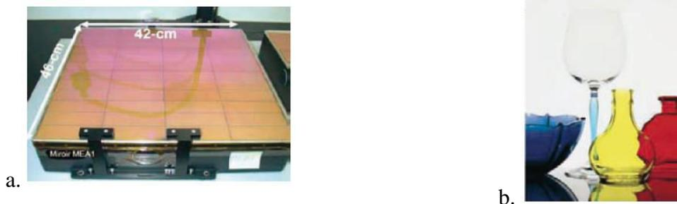
Figure I-2 : a. miroir (cavité laser) recouvert de plusieurs couches hybrides (photo CEA) b. dépôts colorés sur du verre (photo Fraunhofer ISC) [8]
