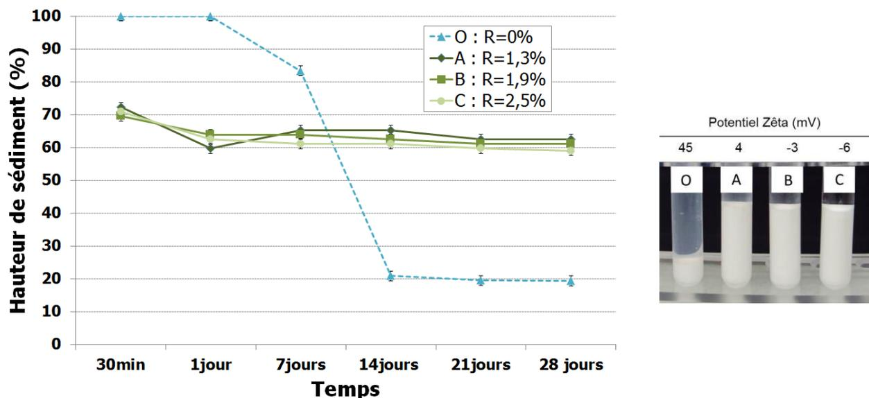
Figure IV-14 : test de sédimentation du système de référence silice/alumine
