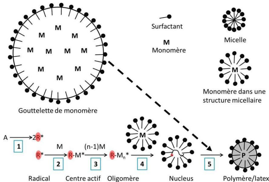
Figure I-8 : mécanisme de polymérisation radicalaire en émulsion micellaire
