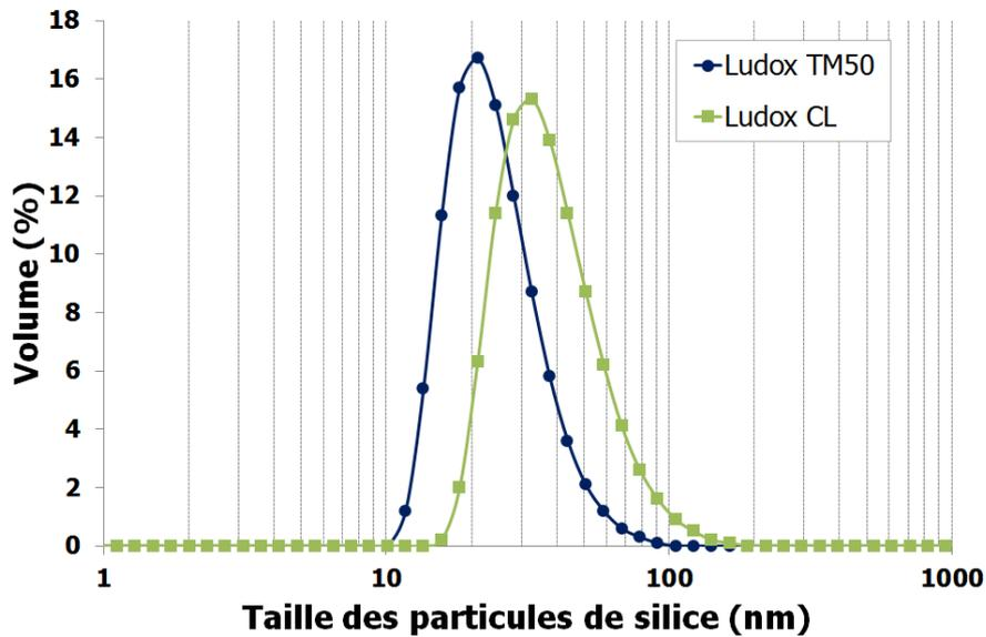
Figure III-1 : distribution en taille des particules de silice
