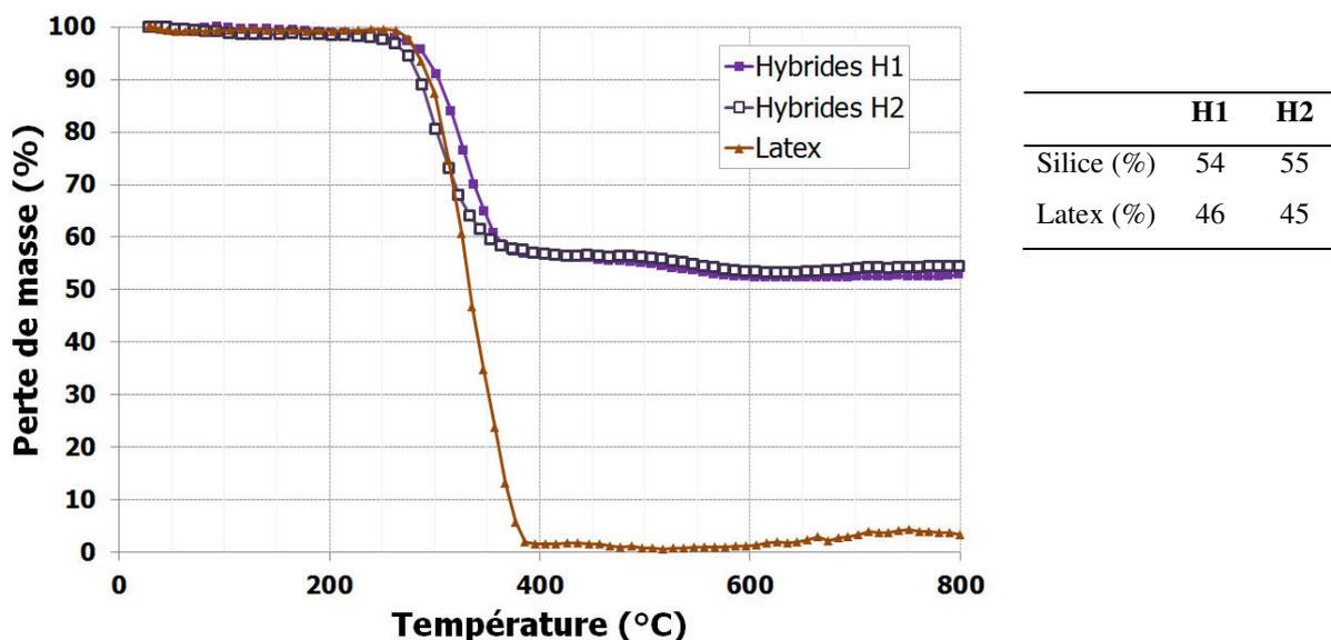
Figure IV-9 : analyse thermogravimétrique des particules hybrides et du latex de polystyrène
