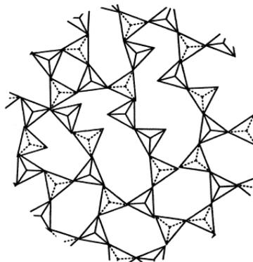
Figure I-4 : structure tétraédrique de la silice (état amorphe).
