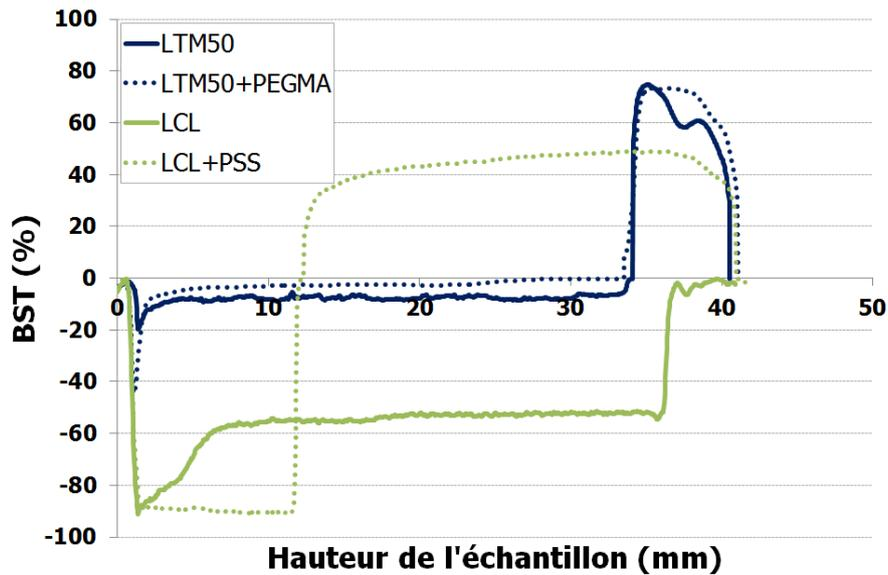
Figure III-8 : analyse de la turbidité en rétrodiffusion et en transmission à  $t=6h$  des émulsions stabilisées par le Ludox TM50 avec et sans PEGMA et le Ludox CL avec et sans PSS
