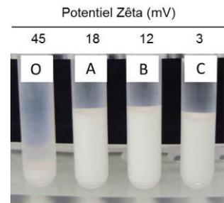
Figure IV-17 : tests de sédimentation pour l'ajout de particules hybrides silice/latex à la suspension d'alumine
