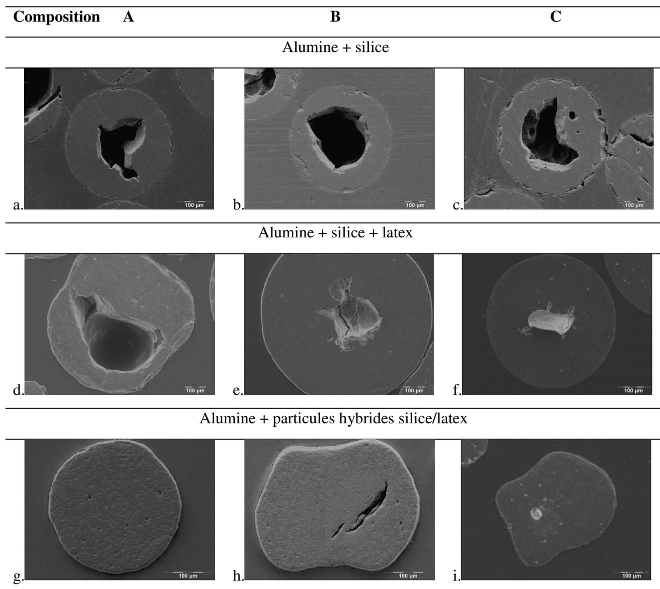
Figure IV-22 : images MEB montrant la microstructure interne des granules après traitement thermique avec pour agent agglomérant : la silice a.  $R=1,3\%$ – b.  $R=1,9\%$ – c.  $R=2,5\%$  ; la silice et le latex d.  $R=1,3\%$  – e.  $R=1,9\%$  – f.  $R=2,5\%$  ; les particules hybrides silice/latex f.  $R=1,6\%$  -g.  $R=2,3\%$  -h.  $R=3,0\%$
