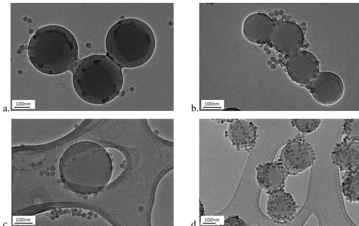
*Figure III-13 : images MET de particules obtenues par polymérisation en émulsion en présence de différentes silices et amorceurs a. Ludox<sup>TM</sup>50 + NaPS - b. Ludox<sup>TM</sup>50 + PEGMA + NaPS - c. Ludox<sup>TM</sup>50 + AIBN - d. Ludox<sup>TM</sup>50 + PEGMA + AIBN*
