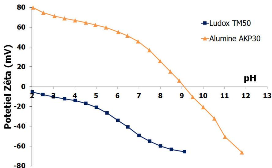
Figure IV-2 : potentiel zêta de la silice Ludox TM50 et de l'alumine AKP30 en fonction du pH
