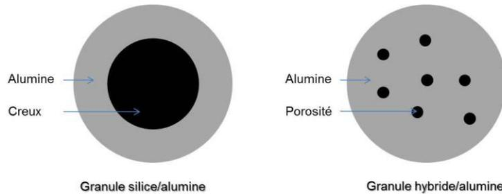
Figure IV-23 : schéma de la structure interne des granules
