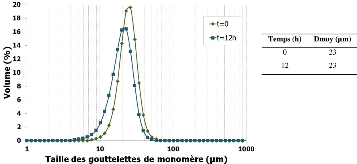
Figure II-18 : distribution granulométrique des gouttelettes de monomère et diamètre moyen des émulsions avec de la silice + PEGMA avec et sans temps d'adsorption
