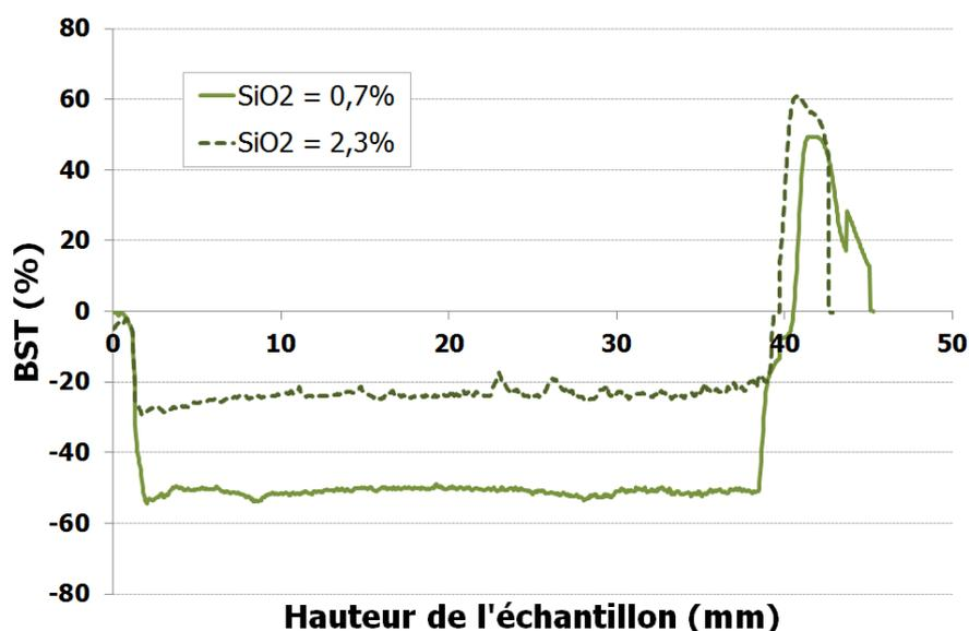
Figure II-17 : analyse en rétrodiffusion et en transmission à  $t=6h$  des émulsions lorsque la silice est introduite à 0,7% et à 2,3% en masse
