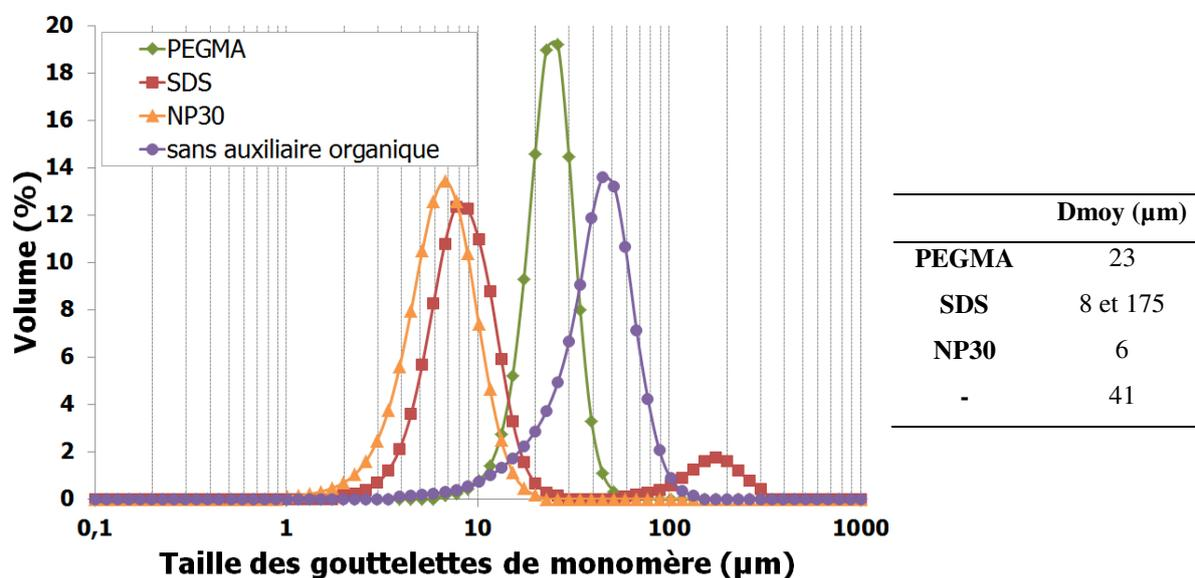
Figure II-14 : distribution granulométrique des gouttelettes de monomère et diamètres moyens des émulsions avec pour auxiliaires organiques le PEGMA (1,2g/L), le SDS (17,3g/L), le NP30 (3,5g/L) et une émulsion sans auxiliaire organique
