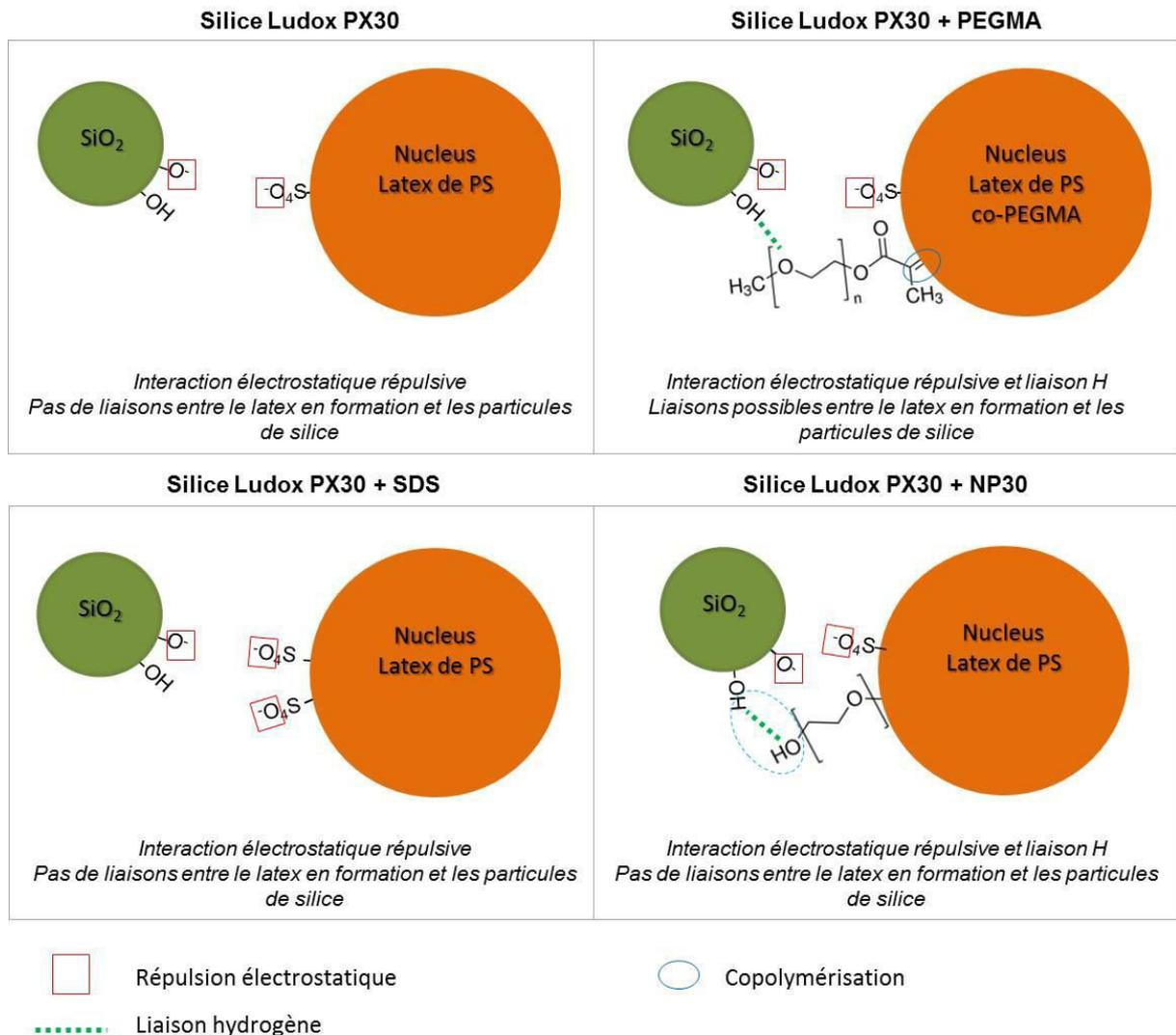
Figure II-34 : interactions entre la silice et le latex selon les différents constituants introduits
