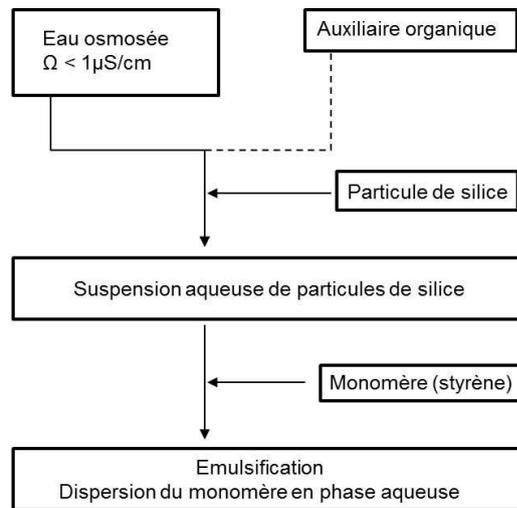
Figure II-12 : protocole de préparation des pré-émulsions
