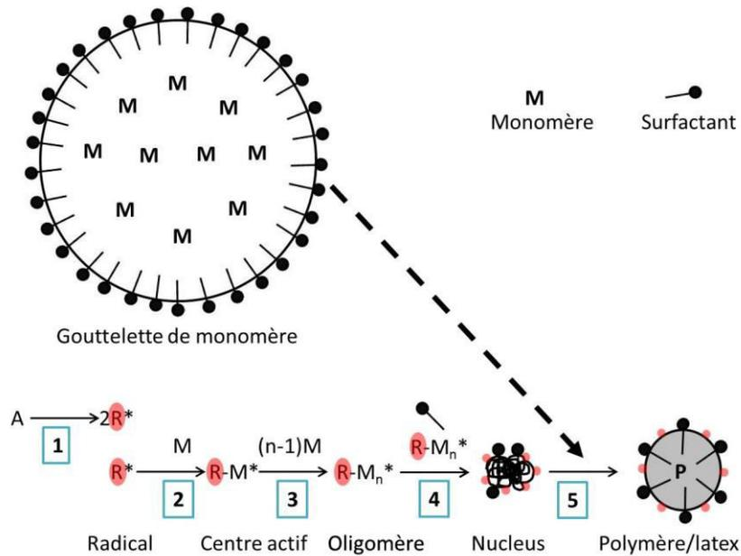
Figure I-9 : mécanisme de polymérisation radicalaire en émulsion homogène
