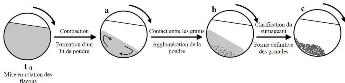
Figure IV-19 : schématisation du procédé de granulation [128]
