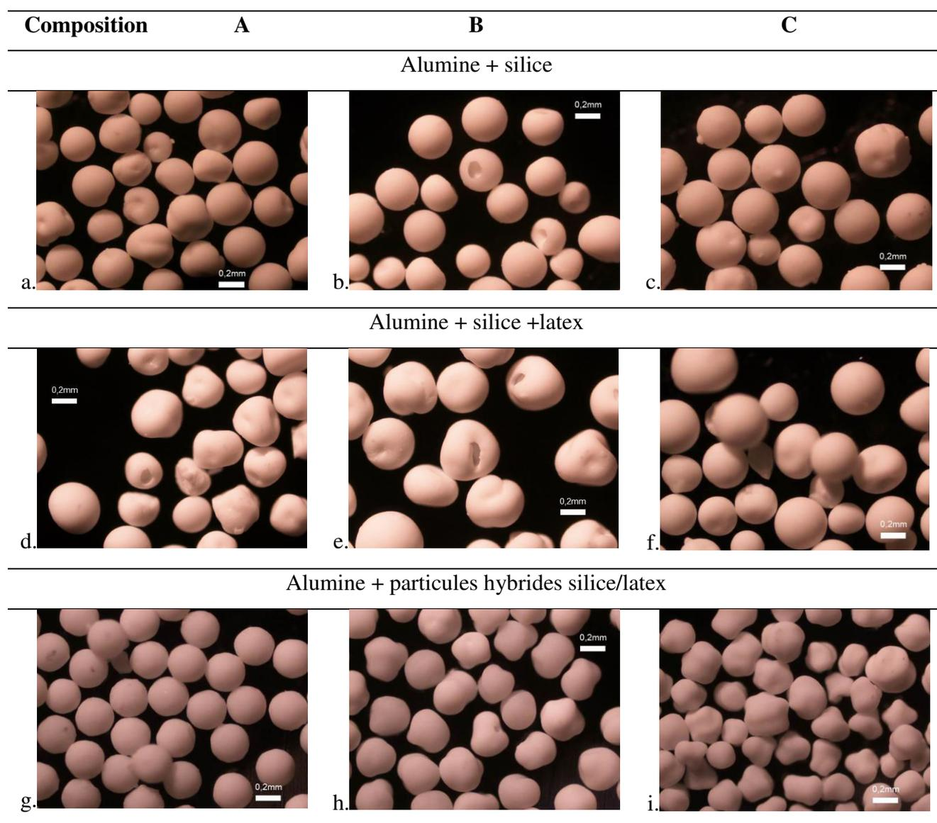
Figure IV-21 : observation en microscopie optique des granules après traitement thermique avec pour agent agglomérant : la silice a.  $R=1,3\%$  – b.  $R=1,9\%$  – c.  $R=2,5\%$  ; la silice et le latex d.  $R=1,3\%$  – e.  $R=1,9\%$  – f.  $R=2,5\%$  ; les particules hybrides silice/latex g.  $R=1,6\%$  -h.  $R=2,3\%$  -i.  $R=3,0\%$
