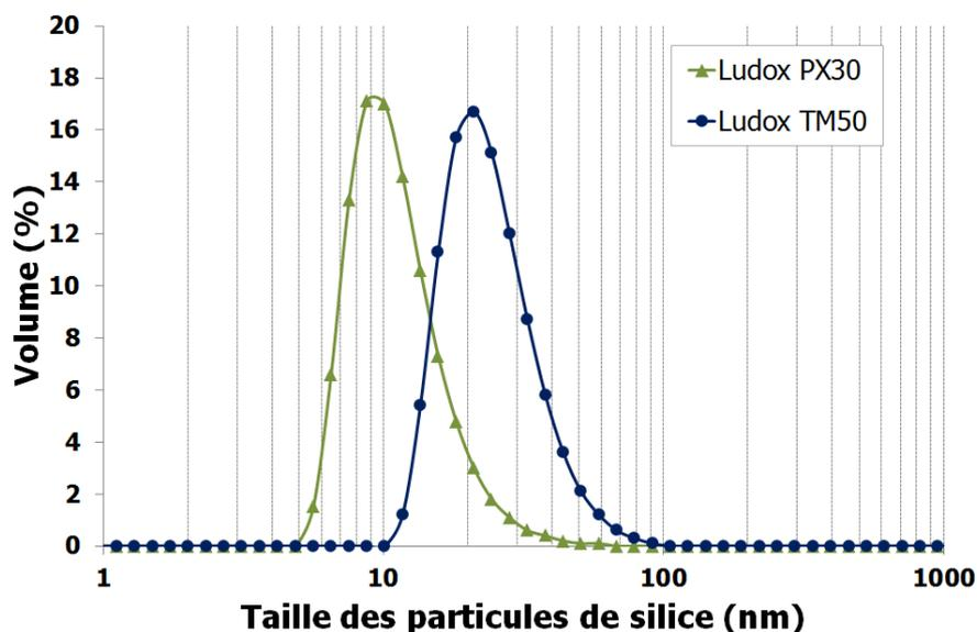
Figure II-7 : distribution en taille des particules de silice
