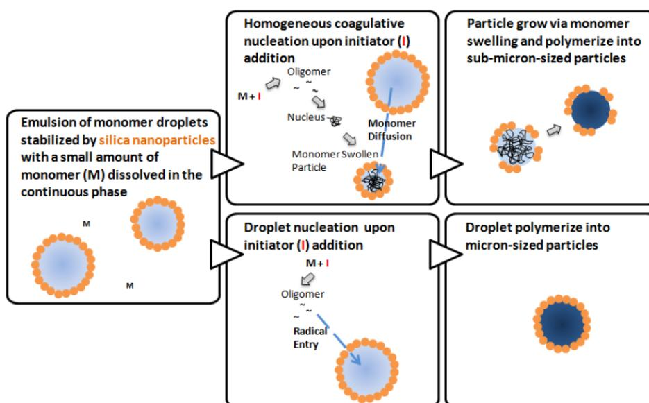
Figure I-17 : schémas des deux mécanismes de polymérisation en présence de silice pour la synthèse de particules décorées silice/latex [87]
