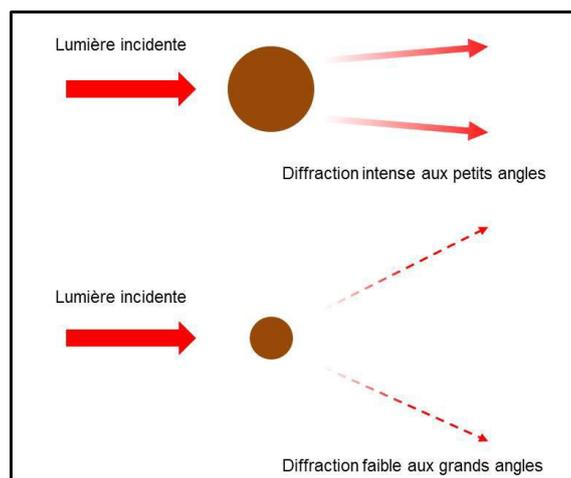
*Figure A3-1 : diffraction de la lumière incidente dans le cas d'une grosse particule et d'une petite particule*
