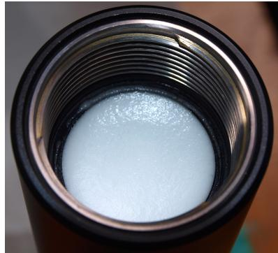
FIGURE 4.4 – Une mousse humique ( $\Phi = 20\%$ ) dans le porte-échantillon d'un tube d'impédance (cliché W. Drenckhan).
