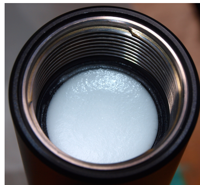
FIGURE 4.4 – Une mousse humique ( \Phi = 20\% ) dans le porte-échantillon d'un tube d'impédance (cliché W. Drenckhan).
