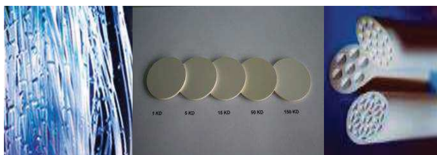
Figure AI.6. 1 : Photographies de membranes fibreuses, planes et mono et multitubulaires.
