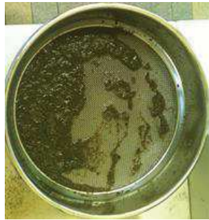
Figure II.5 : Résultat du tamisage du digestat BIOD T4.
