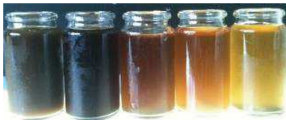
Figure III.3 : Abatement de couleur en fonction du seuil de coupure des membranes (digestat BIOD T1 brut, ultrafiltré à 300 kDa, ultrafiltré à 50 kDa (TERR T2 ici), ultrafiltré à 8 kDa et 1 kDa, respectivement de gauche à droite).
