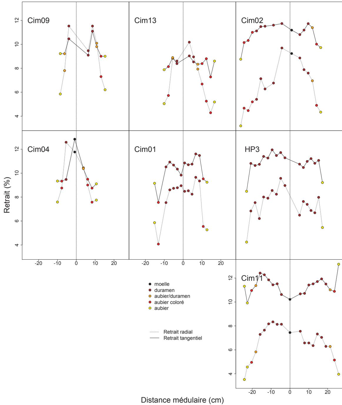
Figure 28 : Le retrait radial ( $R_{rad}$ ) et tangential ( $R_{tan}$ ) en fonction de la distance à la moelle pour chaque arbre.
