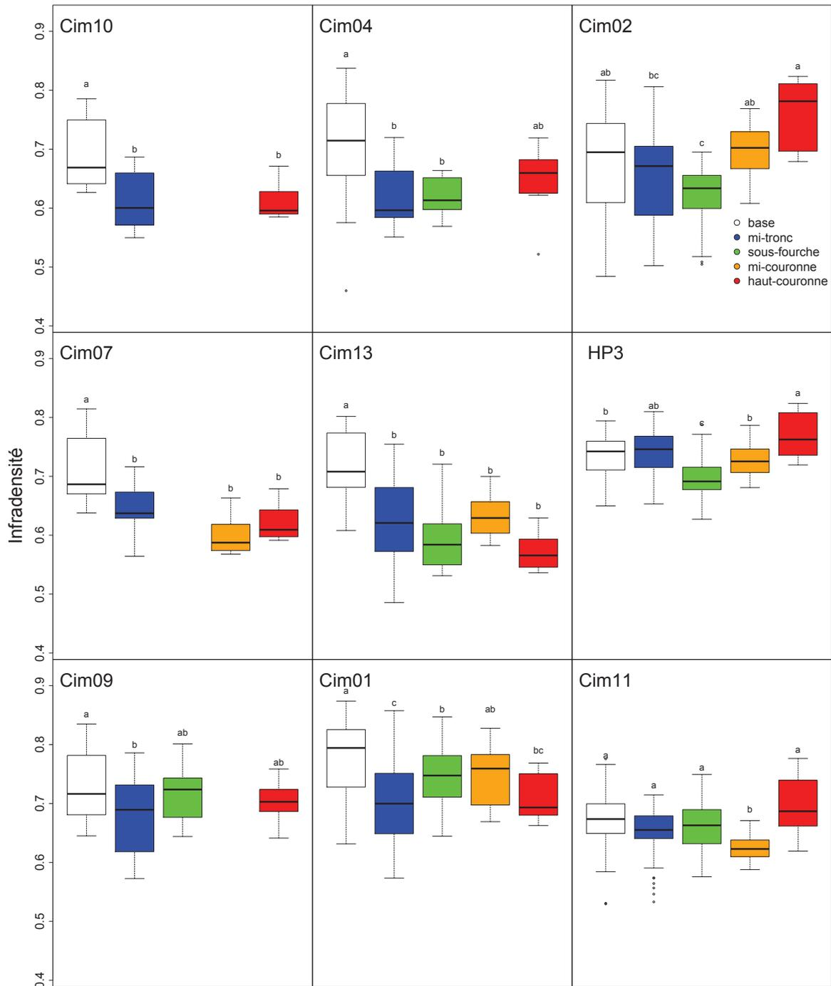
Figure 20 : Variations verticales de l'ID au sein de chaque arbre. Les arbres sont ordonnés par taille (de haut en bas et de gauche à droite). Toutes les éprouvettes mesurées ont été intégrées à l'analyse. Les groupements sont issus de test de Tukey à la suite d'un test de Kruskal-Wallis significatif et permettent les comparaisons de chaque hauteur pour un arbre donné. Les couleurs représentent les différentes hauteurs de prélèvements (voir graphique en haut à droite).
