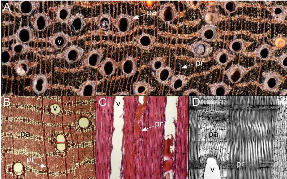
Figure 2 : L'anatomie des plans ligneux chez quelques Fabaceae. Plan transversal chez *Dicorynia guianensis* (A et B). Plan longitudinal tangentiel chez *Inga sp.* (C) et longitudinal radial chez *Parkia bicolor* (D). pa et pr, parenchyme axial et parenchyme de rayon ; v, vaisseau. (Photos : Inside Wood, <http://insidewood.lib.ncsu.edu/>)
