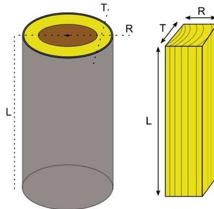
Figure 13 : Les plans d'une éprouvette de bois.
