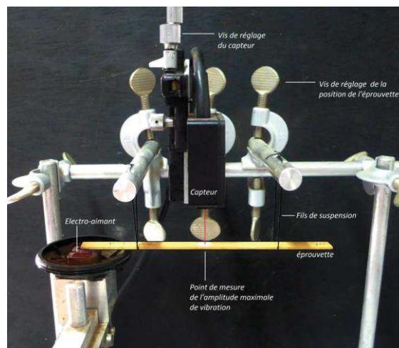
Figure 39 : Le dispositif Vibris.
