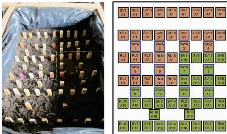
Figure 41 : Disposition des éprouvettes dans le bac.
