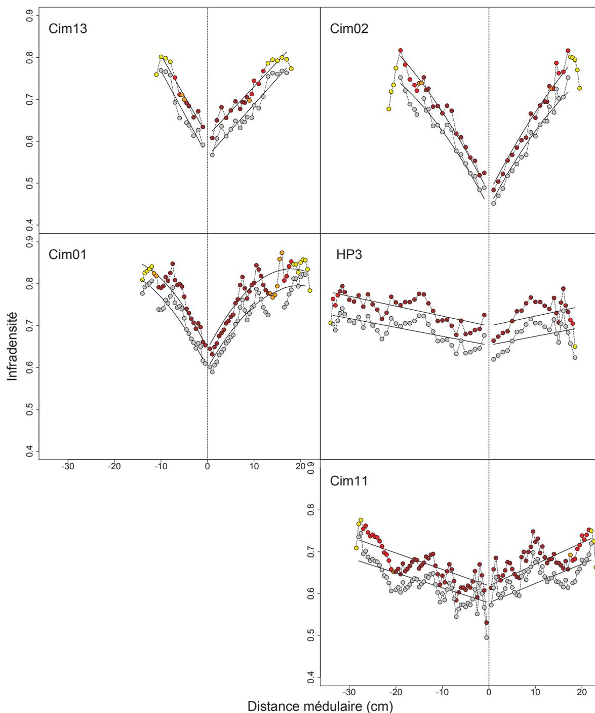
Figure 23 : Profil radiaux d'infradensité (ID) (en couleurs) et d'infradensité corrigée (ID) (gris) des gros arbres.
