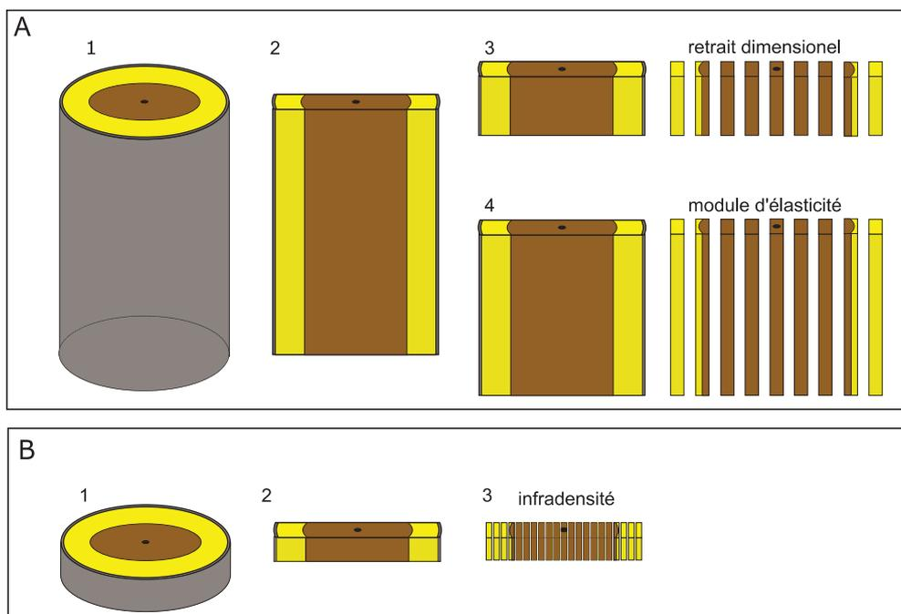
Figure 10 : Organigramme du débit des éprouvettes. Voir explication paragraphe précédent (A), et paragraphe suivant (B).
