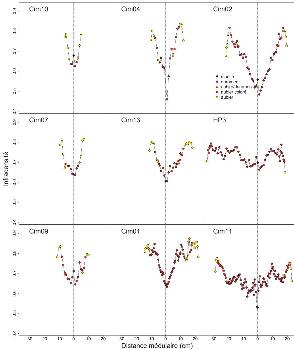
Figure 21 : Profils radiaux d'infradensité des rondelles basses de chaque arbre. Les arbres sont ordonnés par taille (de haut en bas et de gauche à droite). Les couleurs représentent les différents types de bois (voir graphique en haut à droite).
