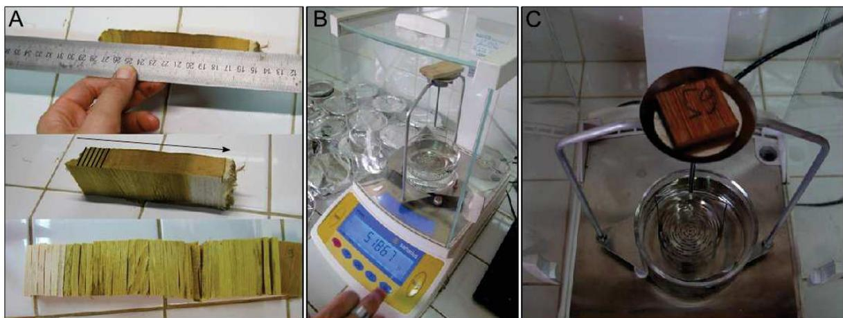
Figure 11 : Débit des éprouvettes d'ID et pesée de la masse verte.
