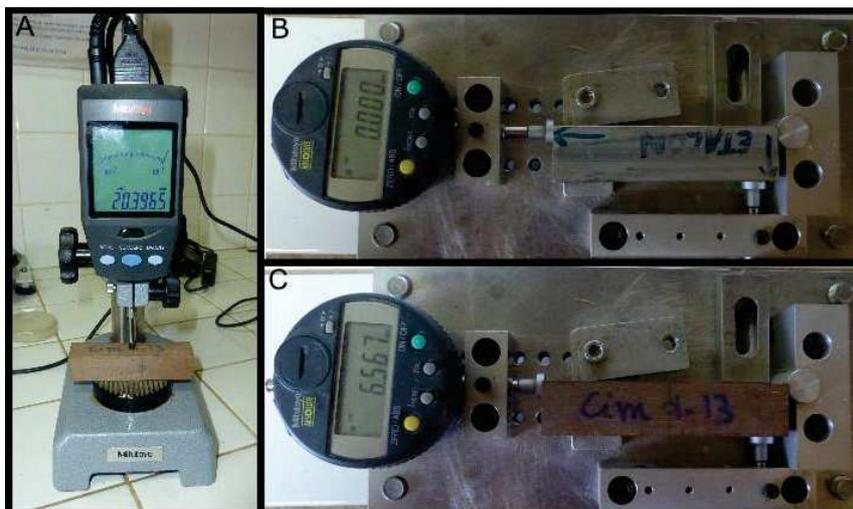
Figure 14 : Mesure des dimensions des éprouvettes de retrait.
