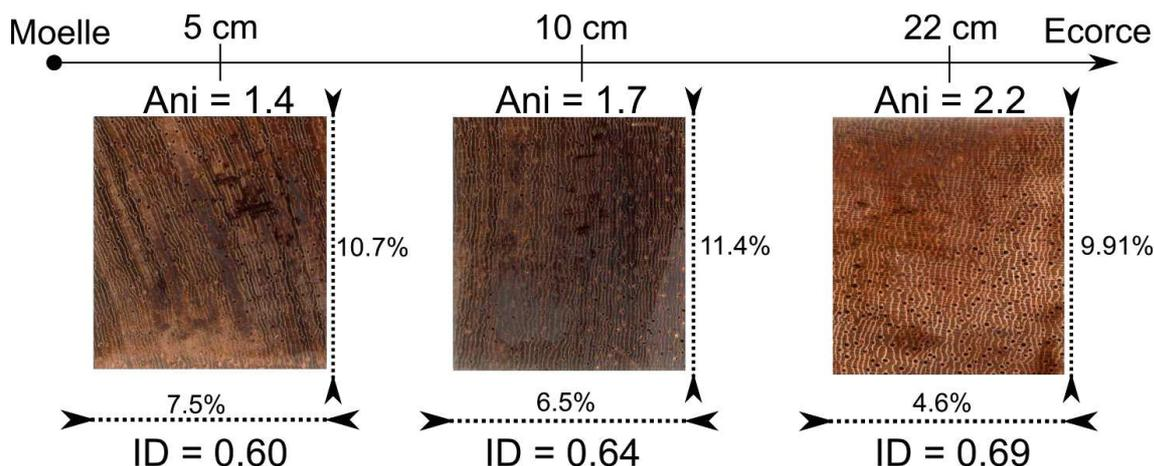
Figure 36 : Surface transversale de 3 éprouvettes de retrait.
