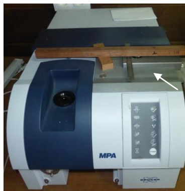
Figure 16 : Mesure de la durabilité par la méthode NIRS.
