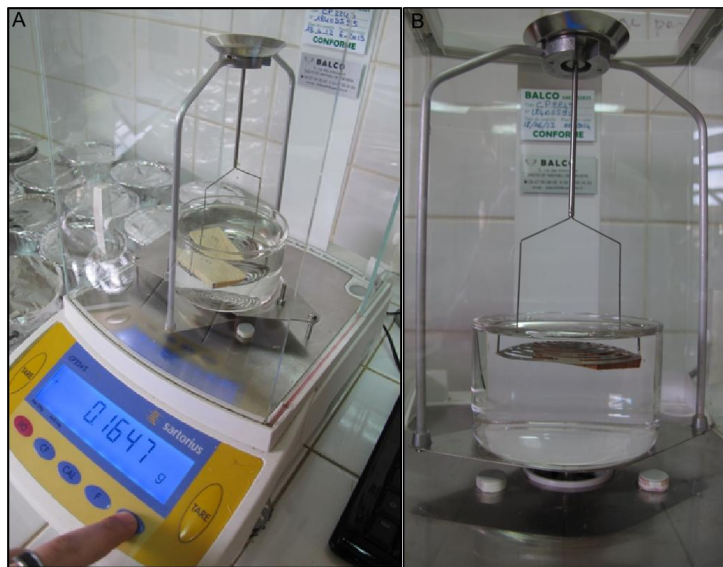
Figure 12 : Pesée de la masse immergée saturée. L'utilisation d'un panier concave (A) ou convexe (B) permet de peser respectivement la masse immergée d'un échantillon qui coule ou qui flotte.
