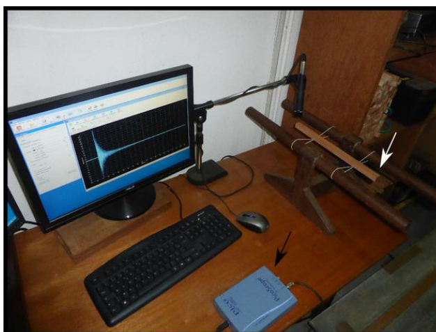
Figure 15 : Mesure du Module d'élasticité par la méthode BING.
