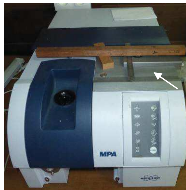
Figure 16 : Mesure de la durabilité par la méthode NIRS.
