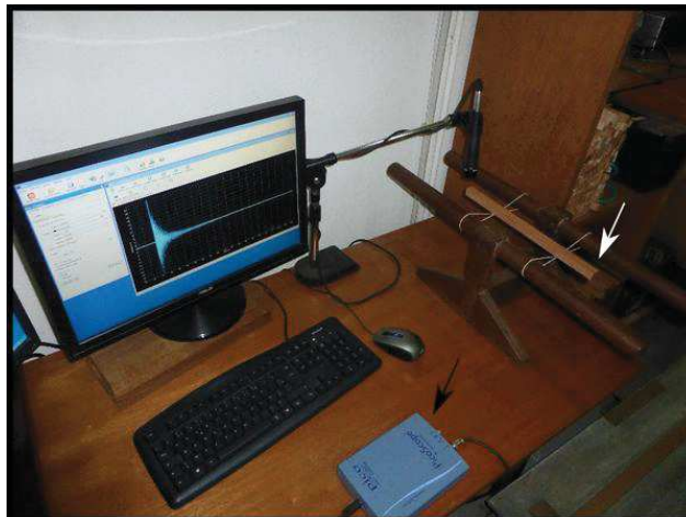
Figure 15 : Mesure du Module d'élasticité par la méthode BING. L'échantillon à tester est posée sur deux élastiques accrochés à un portoir. La sollicitation est appliquée à une extrémité et perpendiculairement à l'axe de l'échantillon (flèche blanche). Le signal analogique est enregistré par le microphone puis transformé en signal numérique par l'oscilloscope (flèche noire).
