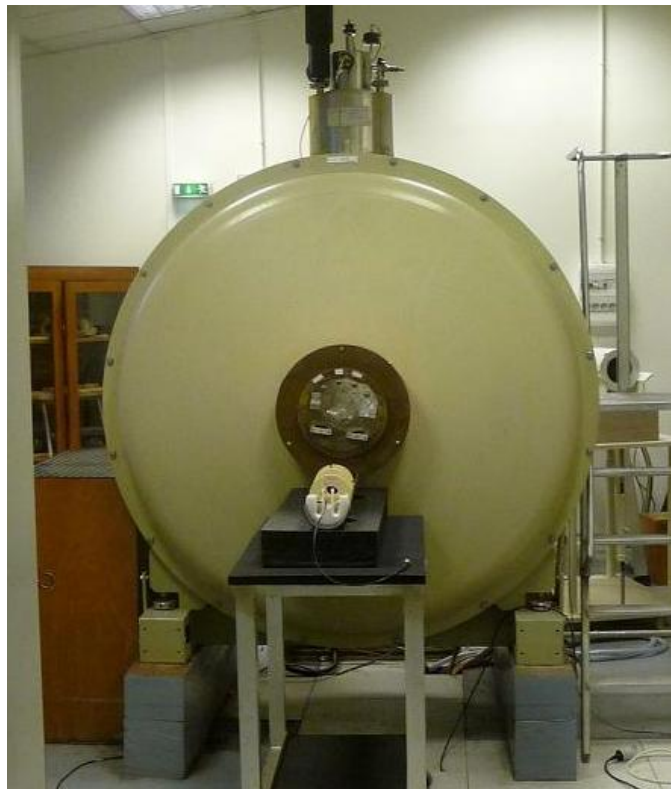
Figure II.58 Imageur de 4.7 Tesla au sein de l'IR4M, image tirée du site d'IR4M.
