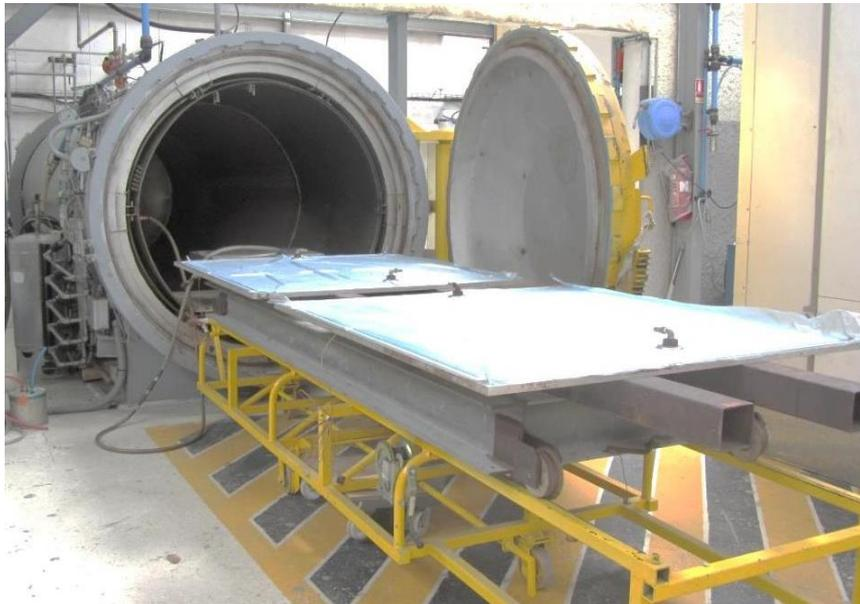
Figure II. 7 - Autoclave utilisé pour la cuisson des éprouvettes [121]
