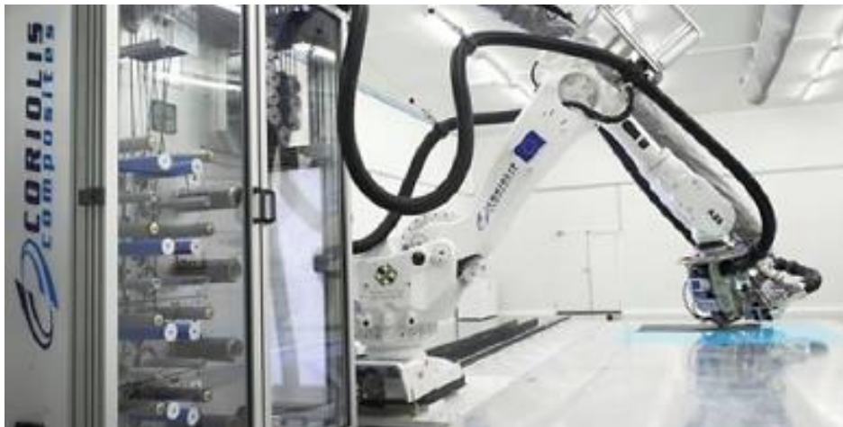
Figure V. 4 - Cellule de placement de fibres automatisé ABB ® utilisée pour le drapage des stratifiés à matrice thermoplastique (développée par Coriolis Composites ® [2])
