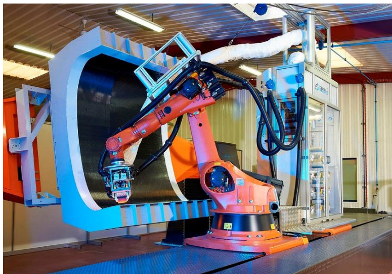
Figure II. 3 - Cellule de placement de fibres automatisé Kuka® utilisée pour le drapage des stratifiés (développée par Coriolis Composites [2])
