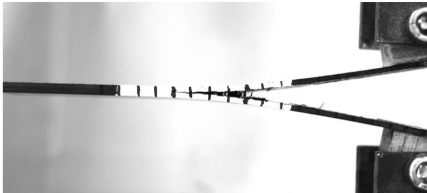
**Figure IV. 16** - Photographie d'une éprouvette de référence drapée par AFP (gap 0,5 mm) testée en Mode I avec la présence de pont de fibre entre les deux plis centraux orientés à 90°, empilement  $[0^{\circ}_7/90^{\circ}_2/0^{\circ}_7]$
