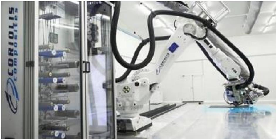
Figure V. 4 - Cellule de placement de fibres automatisé ABB<sup>®</sup> utilisée pour le drapage des stratifiés à matrice thermoplastique (développée par Coriolis Composites<sup>®</sup> [2])
