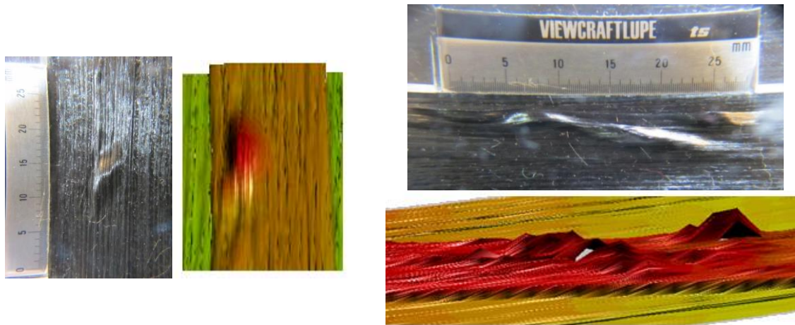
Figure VII. 4 - Photographie des défauts présents à la surface des rubans et les modélisations correspondantes
