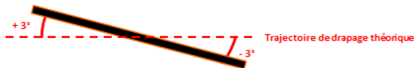
Figure II. 6 - Déviation angulaire autorisée par les constructeurs aéronautiques lors du drapage d'une pièce de structure de forme non développable
