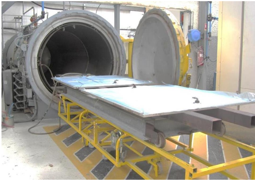
Figure II. 7 - Autoclave utilisé pour la cuisson des éprouvettes [121]
