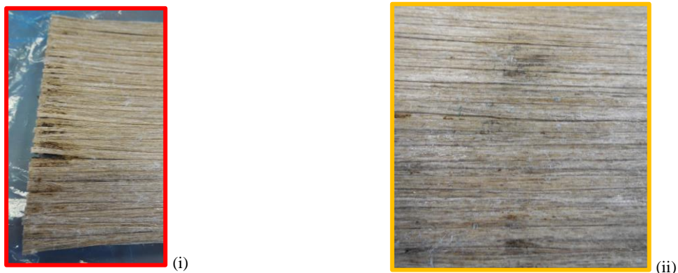
Figure V. 8 - (i) Cintrage de la plaque avec les contraintes résiduelles de chauffage et zones de brûlures dans la zone de réacheminement des rubans ; (ii) brûlures au centre de la plaque
