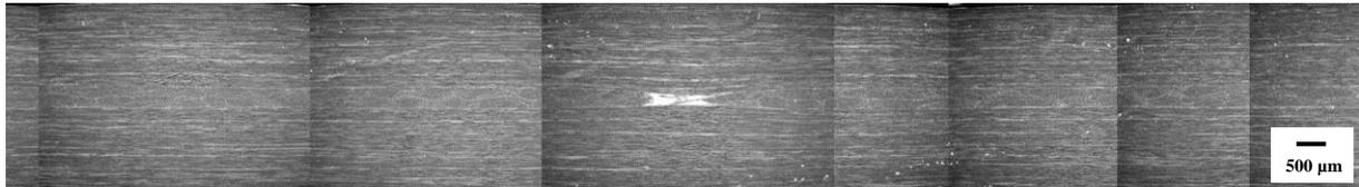
**Figure IV. 9** - Rappel de la microstructure d'un stratifié contenant un gap de 6,35 mm drapé par AFP, empilement  $[0^{\circ}_7/90^{\circ}_2/0^{\circ}_7]$ : (i) Polymérisation sans contre plaque ; (ii) Polymérisation avec contre plaque
