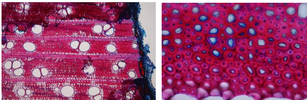
Figure 70 : Coloration d'une coupe anatomique effectuée dans une zone de bois de tension chez C. alliodora . Aucune zone n'indique la présence de tissus non lignifiés (qui apparaîtraient en bleu). On note cependant que l'épaisseur de la paroi des fibres est importante dans cette zone. De gauche à droite, les grossissements sont x10 et x100. Coupes, coloration et photographie effectuées par Barbara Ghislain.
