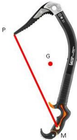
Figure 40. Position du centre de gravité sur un piolet peu galbé
