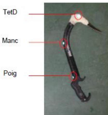
Figure 29. Disposition des marqueurs sur le piolet
