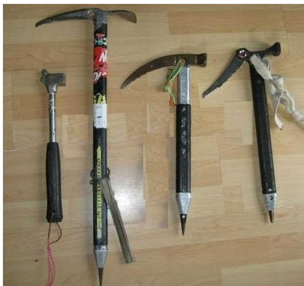
Figure 8. Processus de concrétisation des piolets pour la cascade de glace entre 1971 et 1978 (forum participatif camptocamp)
