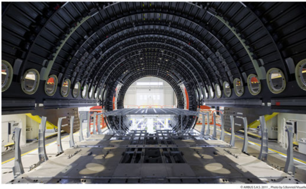
FIGURE 2: Portion de tronçon de fuselage en composite de l'A350XWB. Source site Airbus
