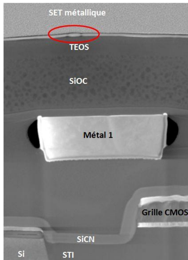
FIGURE 5.3.4 – Coupe TEM d'un SET fabriqué au dessus du premier niveau de métal (Métal 1) d'un procédé CMOS [Jouvet 12]
