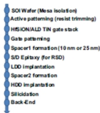
FIGURE 1.2.16 – Organigramme du procédé utilisé pour le tri-gate NW MOSFETs sur SOI [Deshpande 12].
