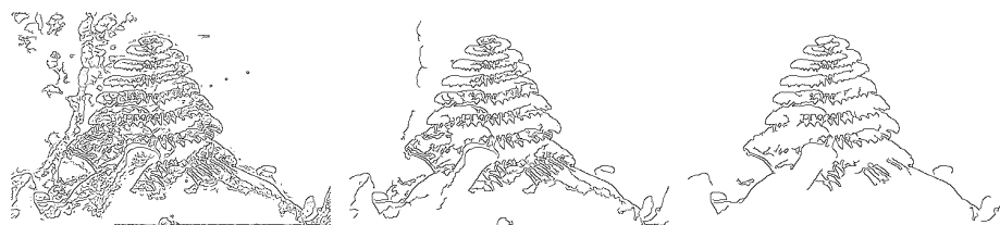
FIGURE 2.4 – Le choix des seuils d'hystérésis est crucial pour obtenir une détection de bords satisfaisante. L'ouverture de filtre est ici fixée à 3. De gauche à droite : le choix de seuils trop faibles conduit à une sur-détection, des valeurs intermédiaires obtiennent un niveau de détail permettant la bonne description de l'objet et des valeurs trop élevées entraînent l'extraction de la seule structure grossière de l'image.
